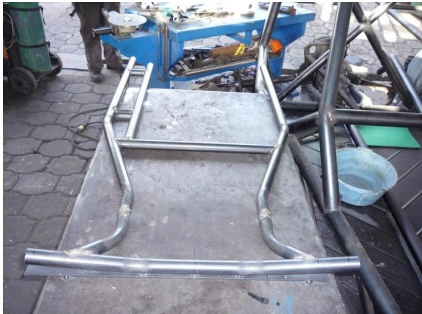
**Figura 3.16:** Soldadura de la Parte Frontal
