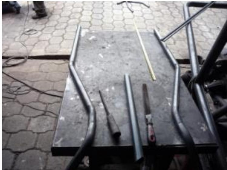
**Figura 3.14:** Alineación de los tubos principales del Chasis
