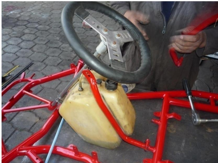
**Figura 3.37:** Montaje del tanque de combustible
