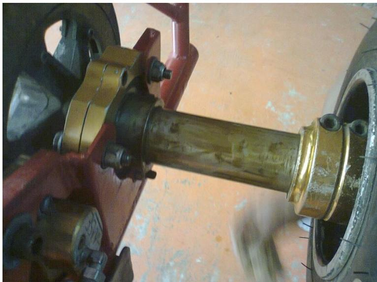
**Figura 3.53:** Lubricación y colocación del eje Posterior
