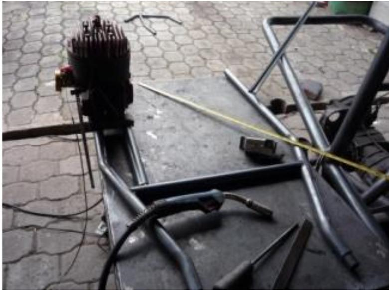
**Figura 3.15:** Alineación del conjunto motriz y soldadura de los tubos interiores
