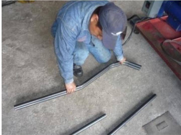
**Figura 3.10:** Doblaje de Tubos parte frontal y posterior
