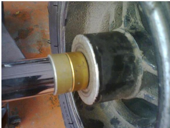
**Figura 3.44:** Colocación de arandelas separadoras
