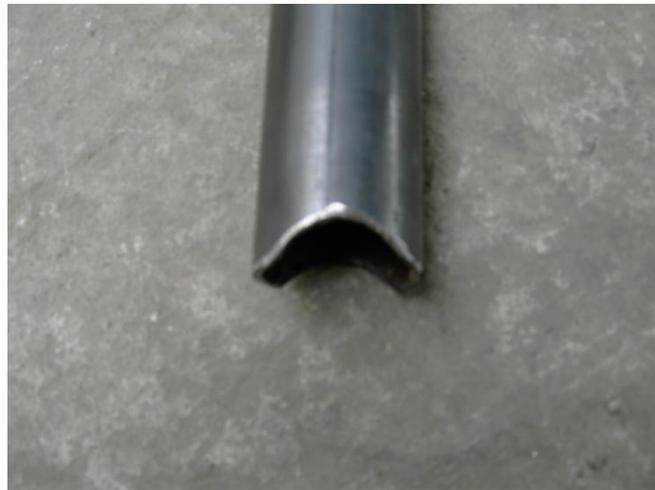
**Figura 1.54:** Corte perfilado o “silla de montar”
