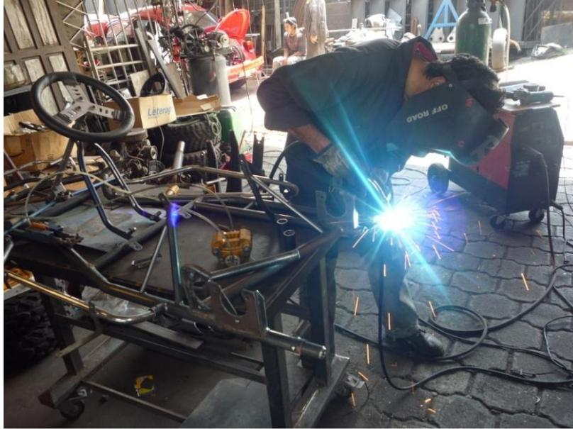
**Figura 3.25:** Soldadura del tubo del Parachoques Posterior.
