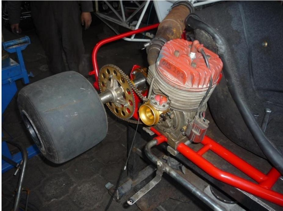
**Figura 3.33:** Montaje del sistema de Escape, Sistema de encendido y Sistema de transmisión.
