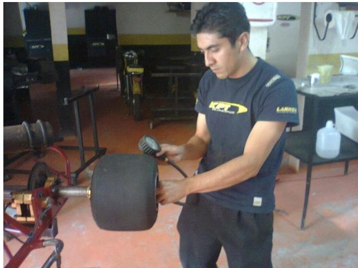
**Figura 3.61:** Revisión de la Presión de Aire de los Neumáticos
