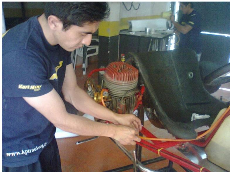
**Figura 3.58:** Colocación del conducto de alimentación principal de la mezcla
