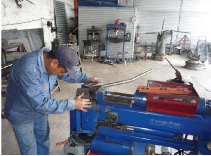
**Figura 3.12:** Doblaje del tubo principal
