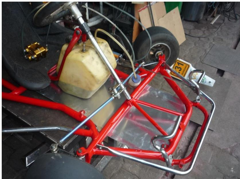
**Figura 3.39:** Colocación de pedales de freno y acelerador, cables, y guardachoques al Chasis
