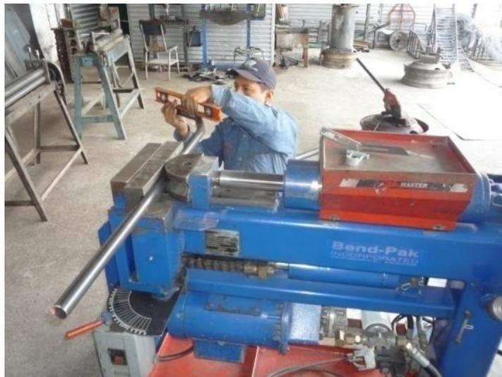
**Figura 3.11:** Medición de ángulos en los Tubos laterales
