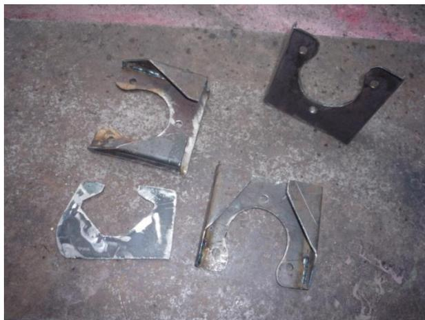
**Figura 3.20:** Soportes del Eje Posterior
