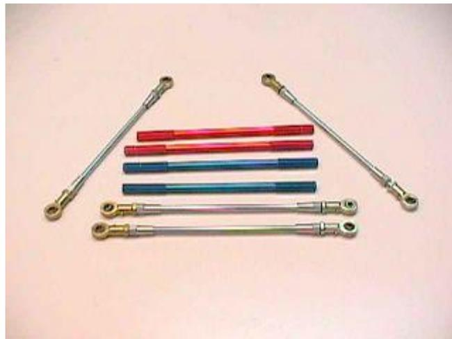
**Figura 1.22:** Varillas y rotulas de dirección
