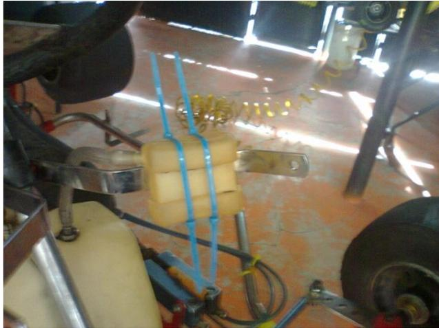
**Figura 3.57:** Colocación del condensador del aceite
