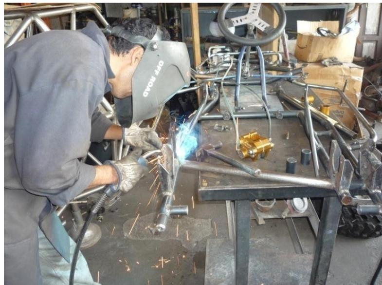
**Figura 3.24:** Soldadura del tubo diagonal al Chasis Cuadro.
