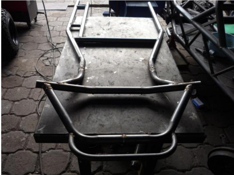
**Figura 3.17:** Unión y Soldadura de la Parte Frontal (protector)
