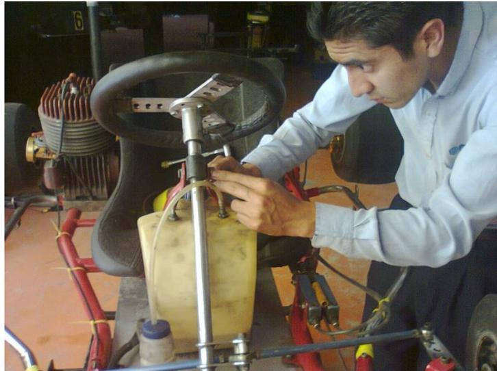
**Figura 3.46:** Ajuste de la Dirección Go-Kart
