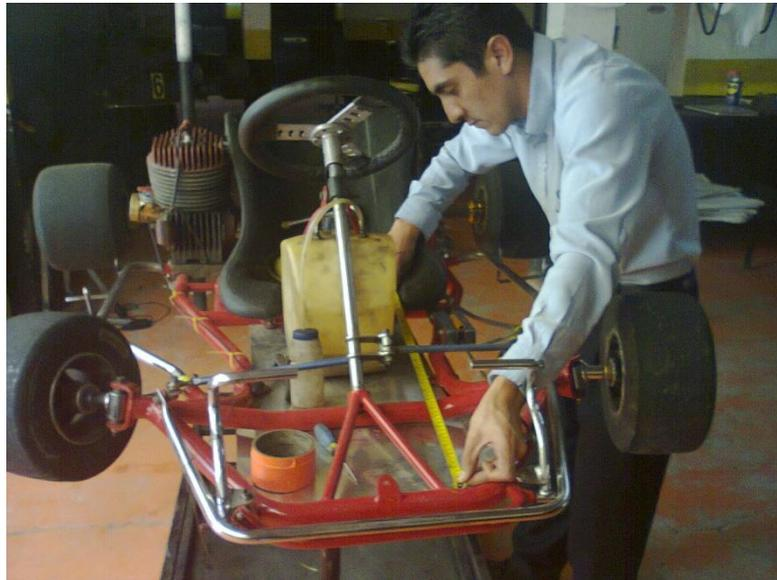
**Figura 3.41:** Distancia y ubicación del Asiento del Piloto parte delantera
