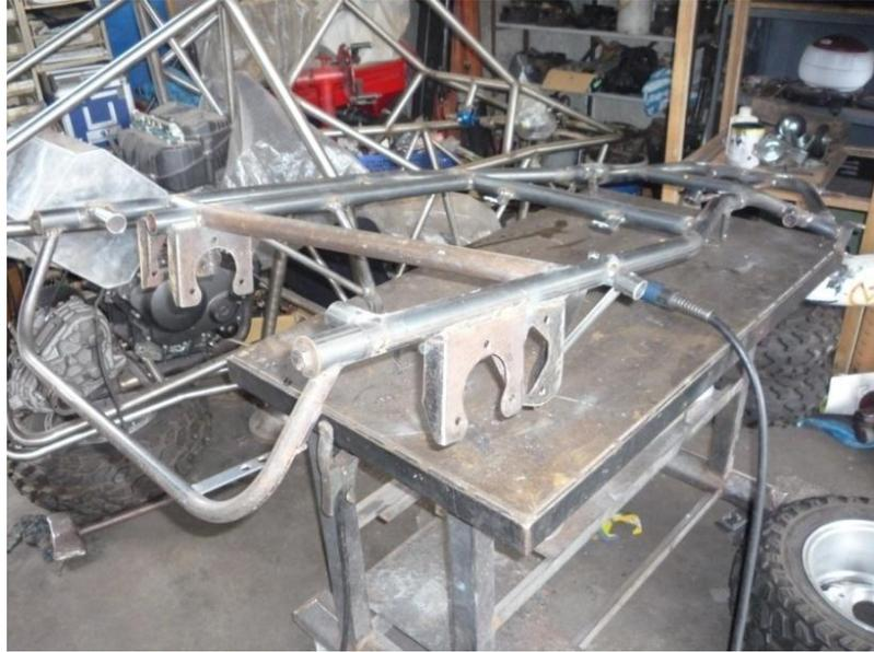
**Figura 3.23:** Alineación del tubo diagonal al Chasis.
