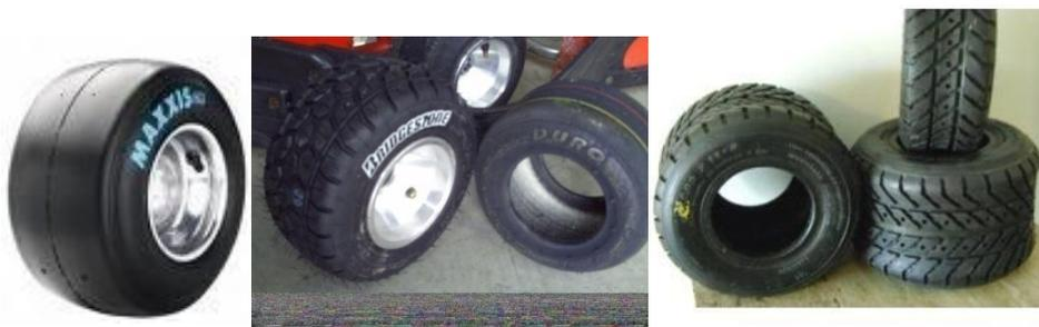
**Figura 1.53:** Neumáticos para asfalto seco, húmedo, y nieve.
