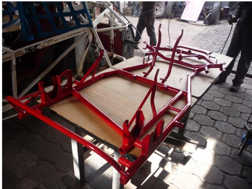
**Figura 3.30:** Proceso de Pintura del Chasis Terminado
