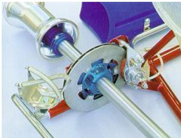
**Figura 1.42:** Eje de transmisión Go-Kart
