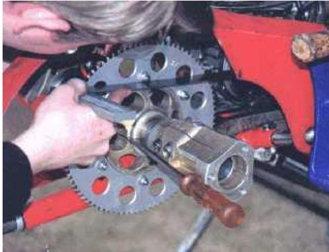
**Figura 3.55:** Alineación de la estrella de Transmisión
