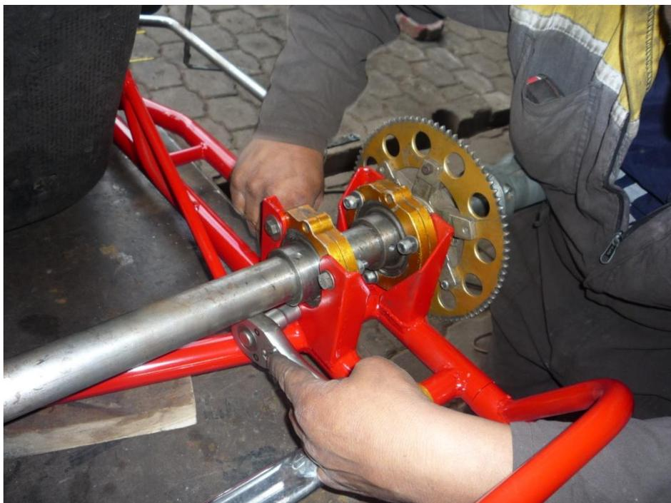
**Figura 3.32:** Montaje del eje posterior
