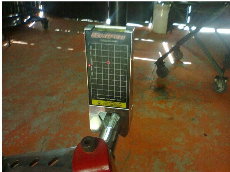
**Figura 3.50:** Alineación del conjunto mediante el rayo de luz.
