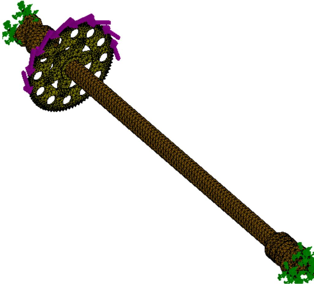
**Figura 2.19:** Mallado del Modelo del Eje de Transmisión
