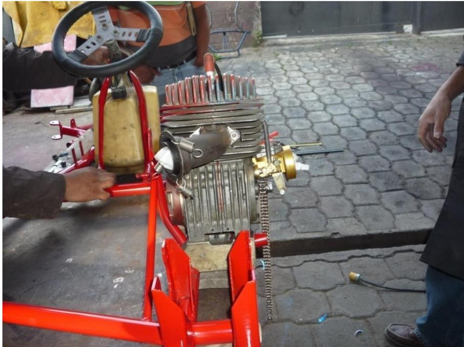
**Figura 3.31:** Posicionamiento del motor y sistema de transmisión
