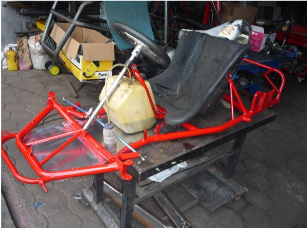
**Figura 3.34:** Montaje de la Columna de Dirección
