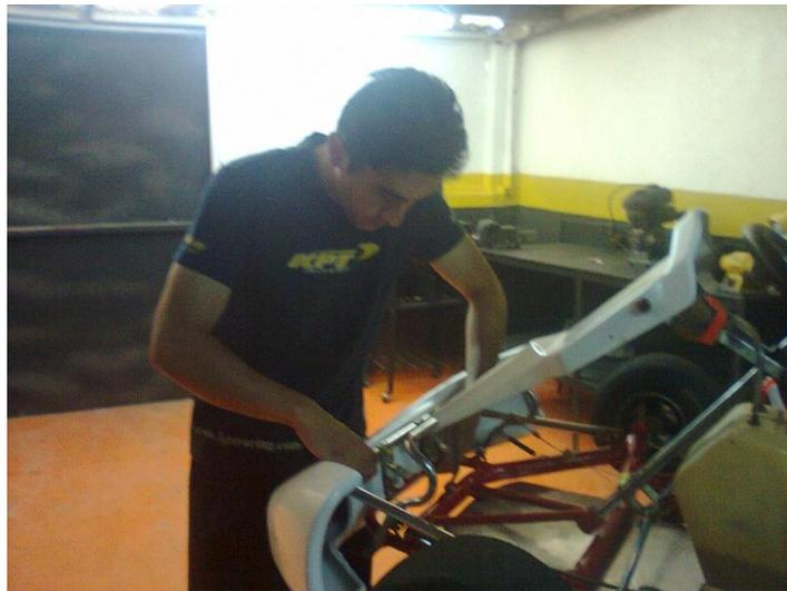
**Figura 3.62:** Colocación de los protectores plásticos
