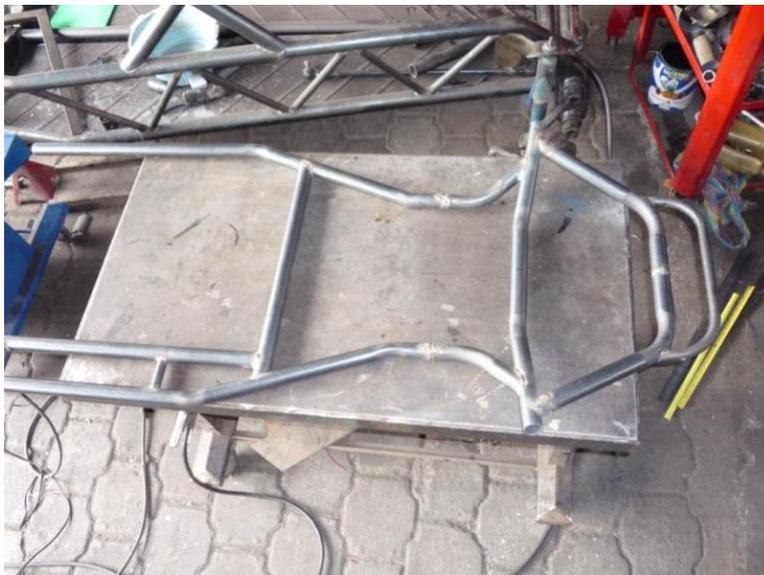
**Figura 3.18:** Unión y Soldadura de la parte frontal (vista lateral)
