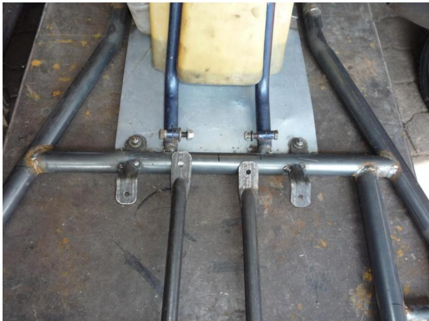
**Figura 3.26:** Soldadura de Anclajes del Asiento, Soporte del Volante y Soporte del tanque de Combustible.
