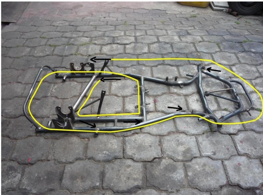
**Figura 1.58:** Método para evitar tensiones en la estructura a soldar
