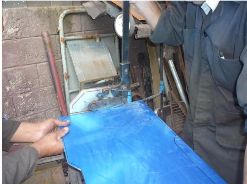
**Figura 3.38:** Fabricación de la bandeja del chasis
