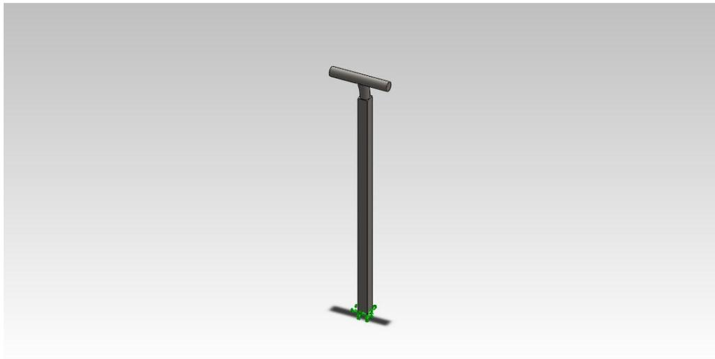
Figura 3.30 Soporte de descanso - colocación de sujeciones.
