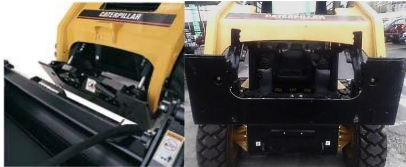
Figura 1.13 Acoplador rápido.
