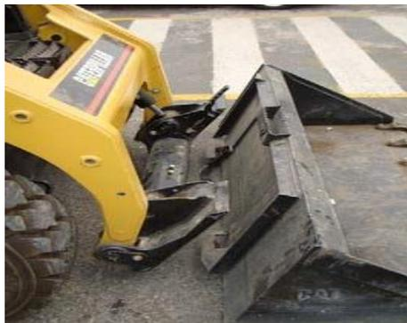
Figura 5.10 herramienta desacoplada.
