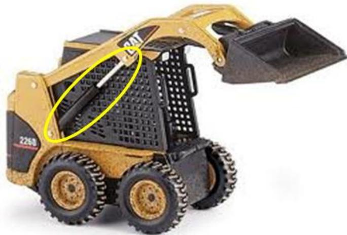
Figura 2.9 Cilindro de minicargadora.
