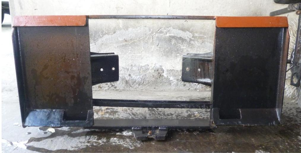
Figura 4.7 Estructura de soporte vista posterior, construido.
