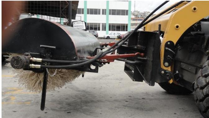
Figura 5.19 Colocación del ángulo.
