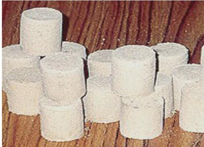
**Figura 3.11** Briquetas de cascarilla de arroz.
