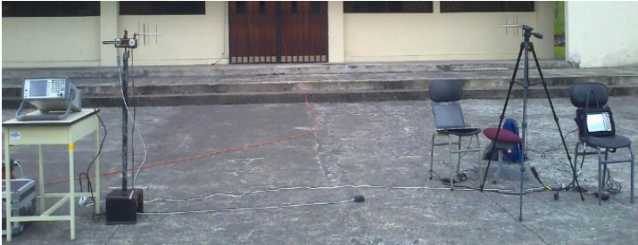
Figura 4: Sistema de Medida de Patrones de Radiación –Completamente Armado.
