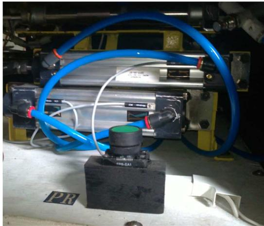
**Pulsador de Reseteo, Cilindro Para las Tapas de Camisa y Cilindro Compactador.**
