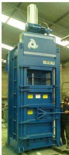
**Figura 2.4.1. Compactadora de envases PET.<sup>4</sup>**
