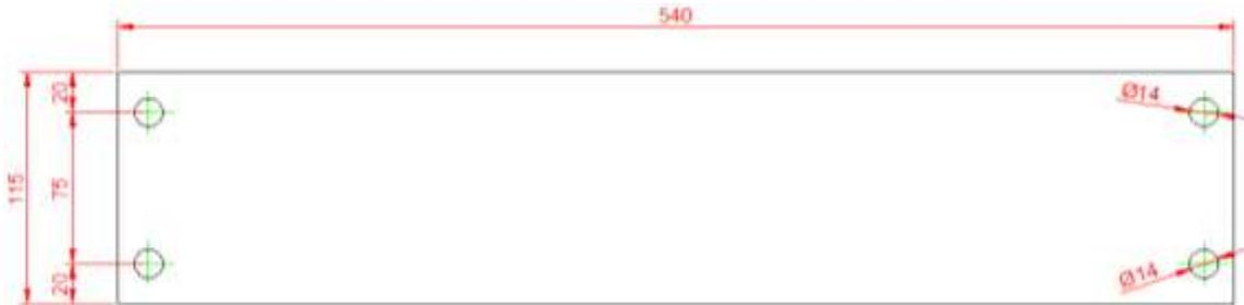
**Figura 4.5.6. Distribución de Pernos en el Cilindro Compactador.**
