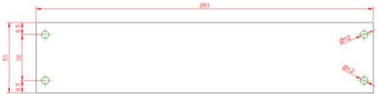
**Figura 4.5.8. Distribución de Pernos en el Cilindro Perforador.**
