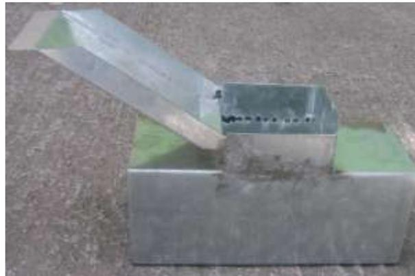
**Figura 5.3.11. Conducto y Rampa de Separación.**
