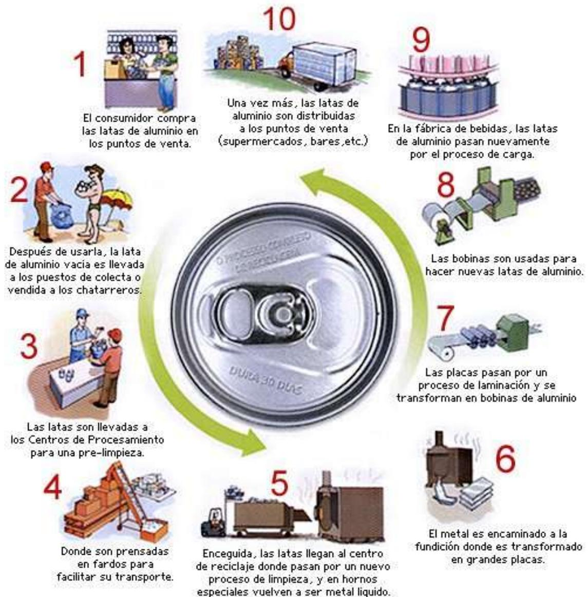
**Figura 2.3.1. Proceso de reciclado del aluminio.** <sup>3</sup>
