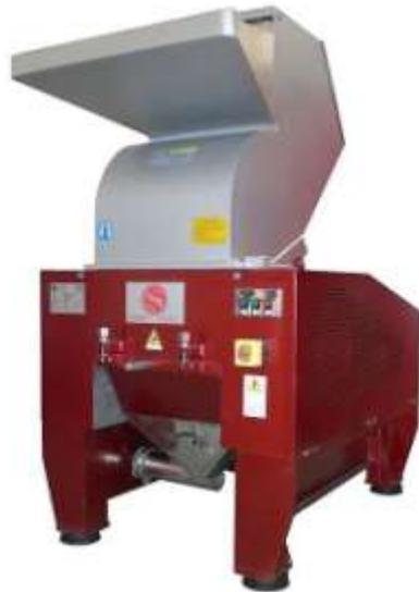
**Figura 2.4.3. Granuladora de plástico.<sup>6</sup>**
