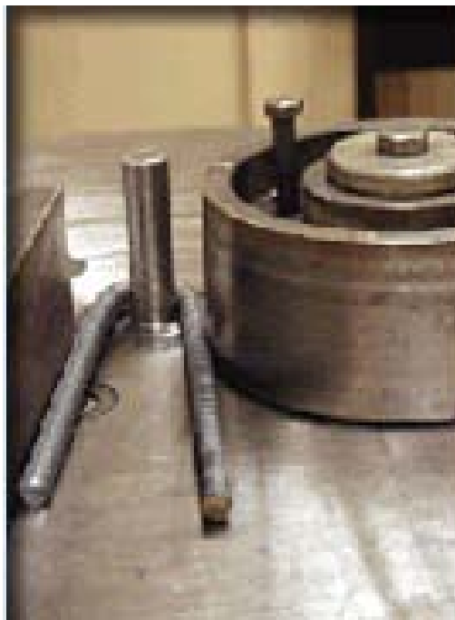
Figura 3.4 Máquina de doblado y colocación de la varilla para realizar el ensayo de doblado a 180° 3.14 .
