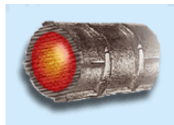
Figura 3.1 Núcleo y capa externa de la varilla ANDEC 3.2
