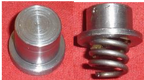
Figura 4.2: Expulsor ubicado en el interior de la matrices de embutición y estampe. Izquierda expulsor, derecha expulsor con muelle helicoidal interior.
