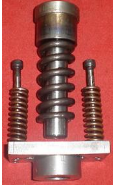
Figura 4.1: Conjunto sujetador de la chapa. Arriba.- punzón con muelle, abajo.- sujetador de la chapa.
