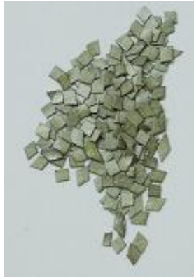
Figura 2.7: Pólvora utilizada en el cartucho de escopeta.
