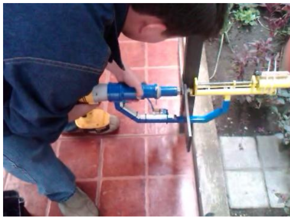
Figura 5.5 Ensamble y desensamble de placas con la máquina prototipo 103
