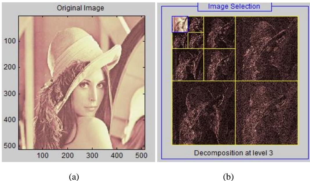
**Figura. 2.5** (a) Imagen original. (b) Resultado tras aplicar 3 niveles de la transformada Wavelet
