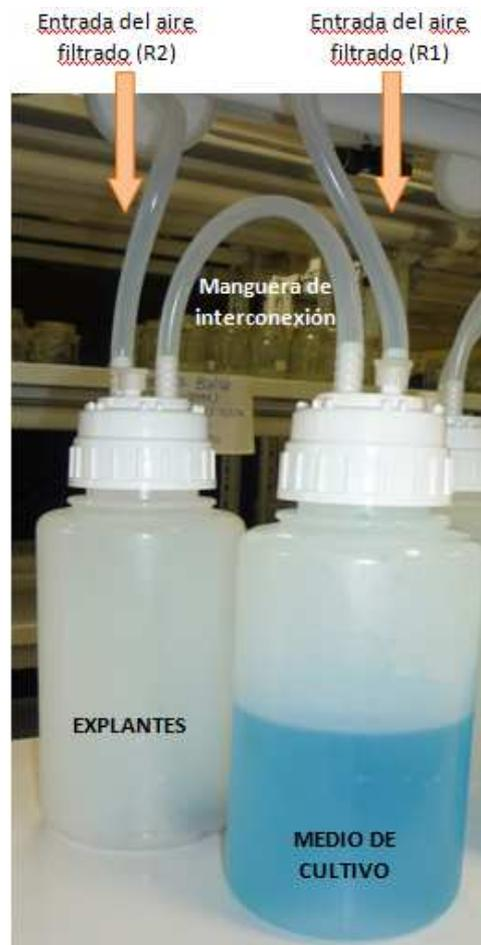
Figura 1.4 Sistema de inmersión temporal adaptado para la multiplicación de plántulas de cilantro cimarrón
