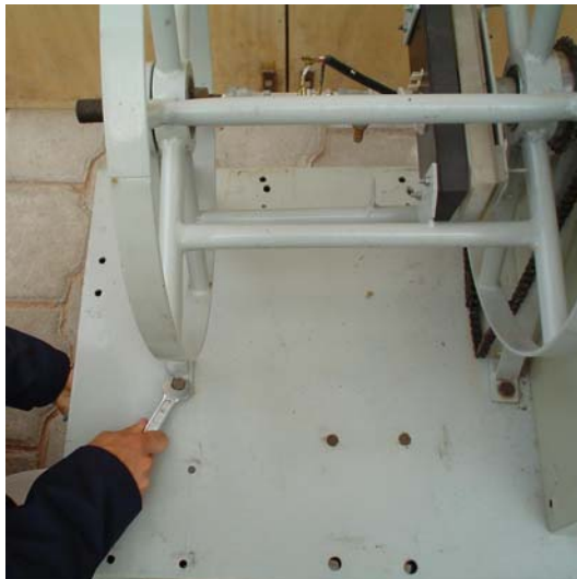
Figura 4.9 Ensamble del carrete sobre la plataforma móvil
