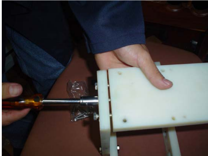
Figura 4.3 Ensamble de la base de la unidad principal
