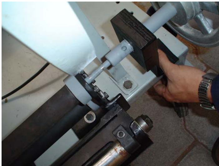
Figura 4.13 Ensamble del subconjunto de templador y acomodador sobre la plataforma móvil
