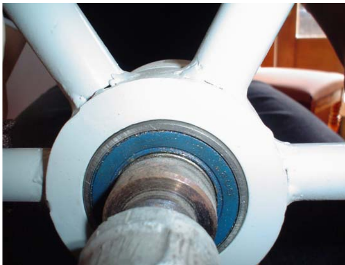
Figura 4.7 Ensamble del tambor del carrete con los semiejes
