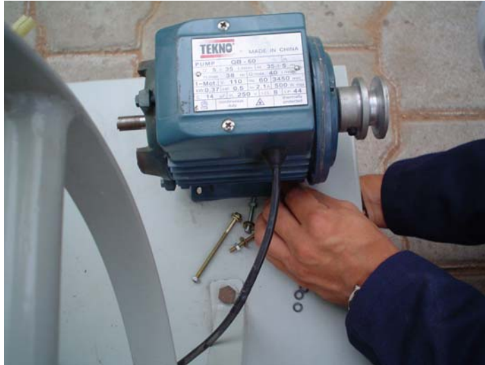
Figura 4.10 Ensamble del motor del acomodador y templador a la plataforma móvil
