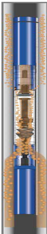
Figura. 2.9. Operación del separador de gas
