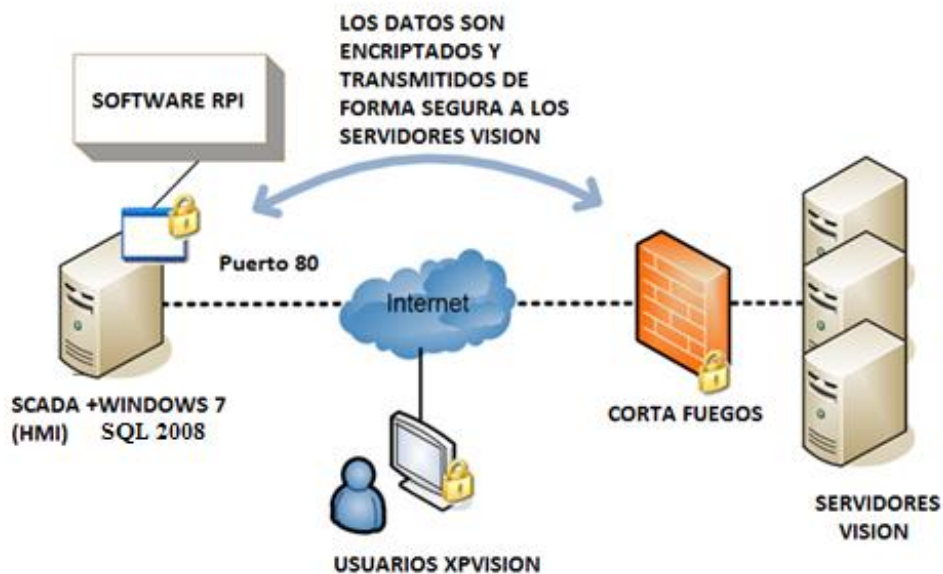
Figura. 4.27. Diagrama de transmisión de datos hacia los servidores Vision
