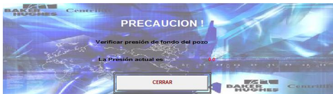
Figura. 3.19. Alarma de baja presión de fondo
