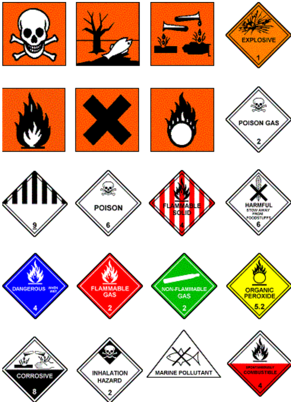
Figura 5.3 Diversos tipos de etiquetados para contenedores de desechos peligrosos. 2
