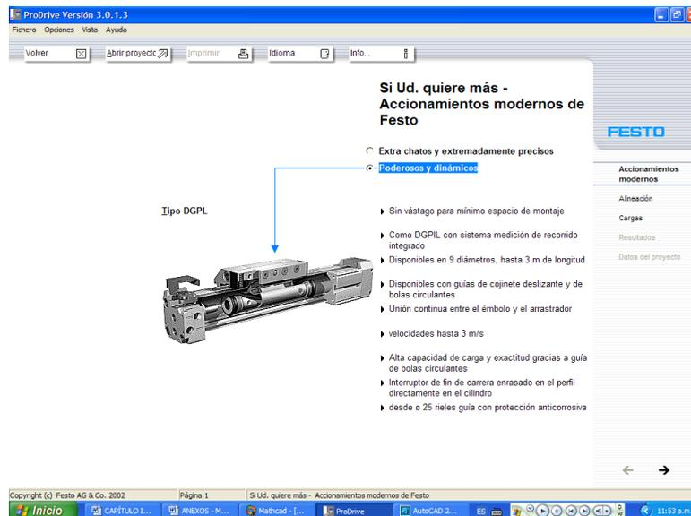
**Figura 4.13 Selección del tipo de actuador lineal. Fuente: Catálogo de Neumática FESTO 2002/2003**
