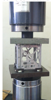
Figura 12: Prototipo "CubeSat" listo para ensayo de fatiga.
