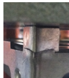
Figura 7: Uno de los vértices deformados del prototipo estructural del picosatélite CubeSat.
