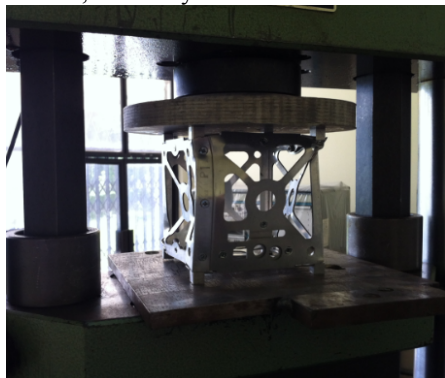
Figura 4: Prototipo tipo CubeSat sometido a ensayo de compresión hasta la falla.
