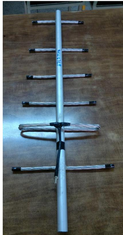
**Figura 3.-** Antena Yagi-Uda implementada
