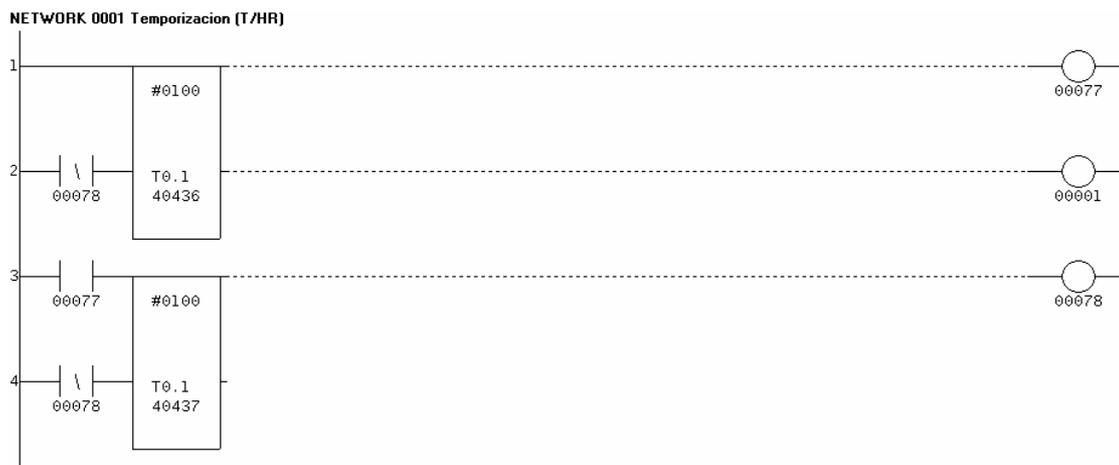
Figura. 6.1. Temporización de temperatura y humedad.
