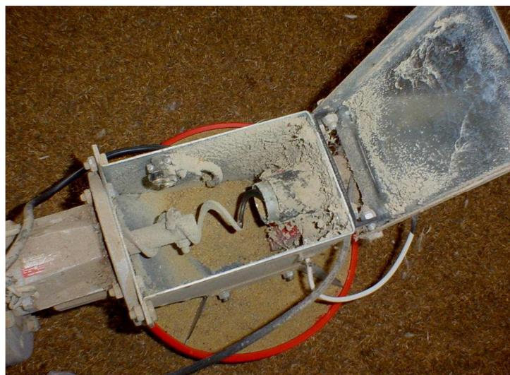
Figura. 4.4. Ubicación de los Sensores en el Plato Sensor
