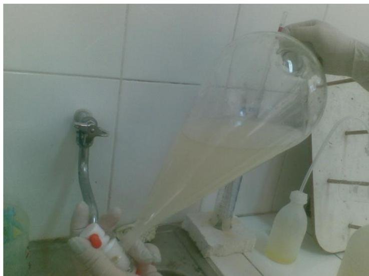
Figura 2. 11 Extracción de TPHs con Diclorometano en embudo de vidrio. En la figura se puede observar la emulsión obtenida por la mezcla entre la muestra y el solvente.
