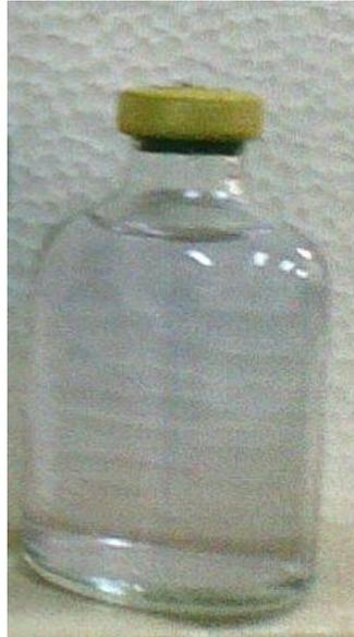
Figura 2. 9 Viales con septo de hule y tapa horadada de metal tipo Wheaton<sup>®</sup>
