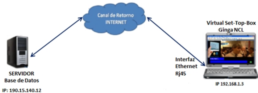
Figura 6.16: Estructura de red para el uso de Canal de Retorno, desde un domicilio ubicado en Quito.
