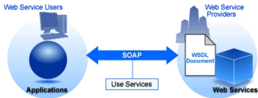
Figura 5.3: Funcionamiento del protocolo SOAP
