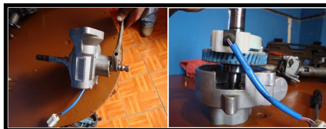
Figura 2.13. Desmontaje del sensor de par Fuente: Los Autores
