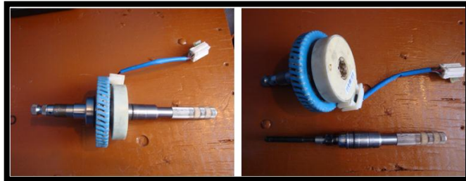
Figura 2.14. Desmontaje de la barra de torsión Fuente: Los Autores
