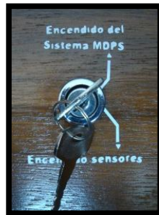
Switch de encendido del sistema MDPS Fuente: Los Autores
