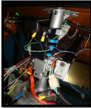
Figura 5.37. Montaje de la batería de 1.3 A y de la placa del motor eléctrico Fuente: Los Autores
