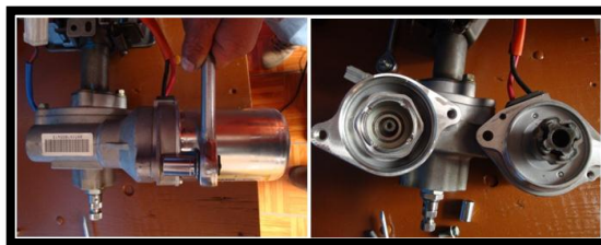
Figura 2.4. Desmontaje del motor eléctrico
