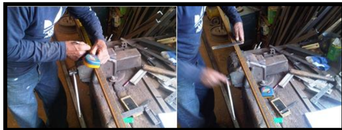
Figura 5.1. Trazado de los perfiles Fuente: Los Autores
