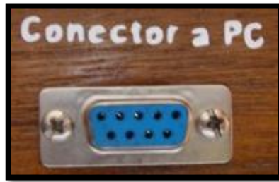
Figura 5.42. Montaje del conector a PC Fuente: Los Autores
