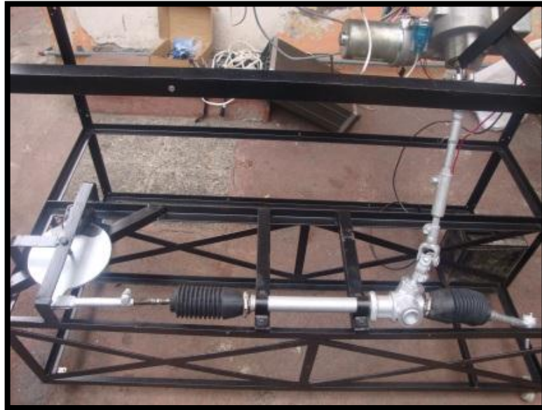
Figura 5.35. Ensamblaje de la caja de dirección Fuente: Los Autores
