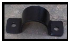
Figura 5.17. Construcción de las abrazaderas de la caja de dirección Fuente: Los Autores
