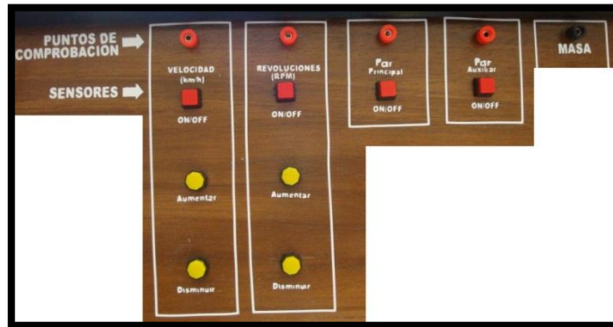
Puntos de comprobación y botones de control de sensores Fuente: Los Autores
