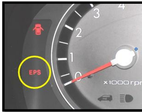
Figura 1.35. Lámpara de testigo de avería Hyundai Accent MC Fuente: EPS & MDPS, Hyundai Chonan Technical Service Training Center
