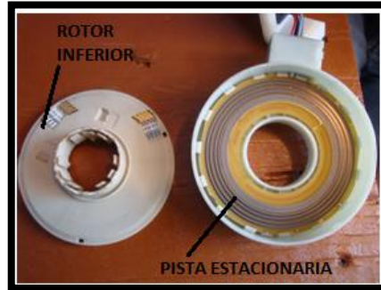
Figura 2.19. Desmontaje del rotor inferior del sensor de par Fuente: Los Autores
