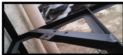
Figura 5.18. Soldadura de los soportes del freno de disco Fuente: Los Autores
