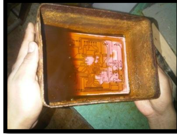
Figura 5.28. Baquelita en recipiente con ácido Fuente: Los Autores
