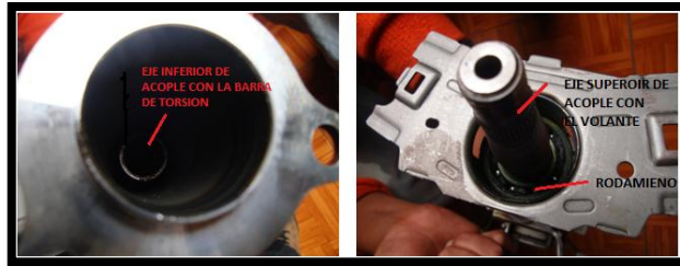
Figura 2.11. Eje interno de la columna de dirección Fuente: Los Autores
