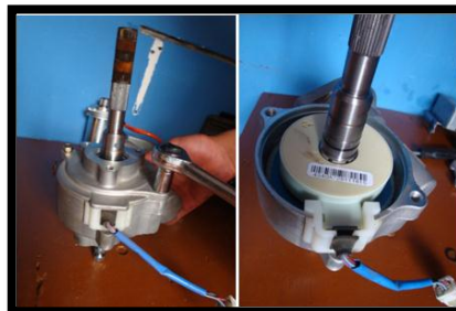
Figura 2.12. Desmontaje de la tapa de la carcasa del sensor de par} Fuente: Los Autores
