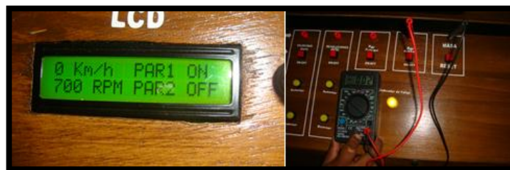
Figura 6.4. Comprobación de Falla C1291
