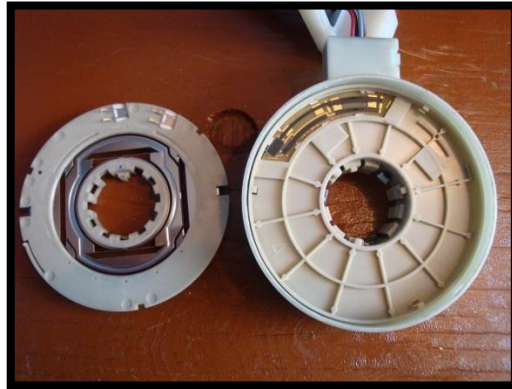
Figura 2.17. Desmontaje del rotor superior Fuente: Los Autores
