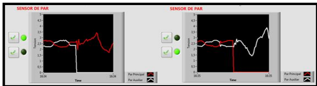
Figura 6.12. Gráficas al desconectar la señal principal y auxiliar de par Fuente: Los Autores
