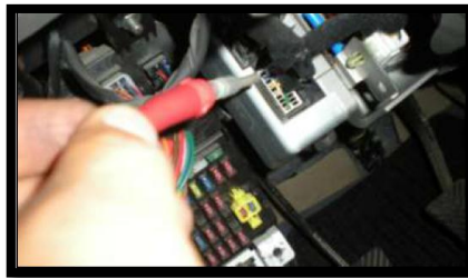
Figura 3.2. Toma de señal de velocidad del vehículo Fuente: Los Autores
