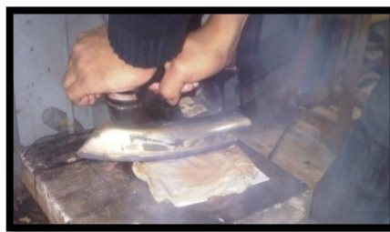
Figura 5.26. Planchado de la baquelita Fuente: Los Autores
