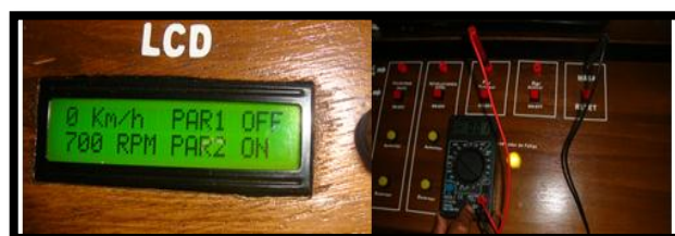
Figura 6.3. Comprobación de Falla C1290
