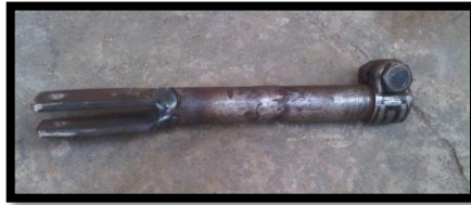
Figura 5.19. Soldadura de la conexión al terminal de dirección Fuente: Los Autores
