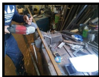
Figura 5.2. Corte de los perfiles Fuente: Los Autores
