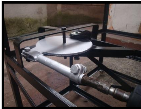
Figura 5.34. Ensamblaje del freno Fuente: Los Autores
