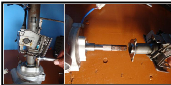
Figura 2.10. Desmontaje de la columna de dirección Fuente: Los Autores
