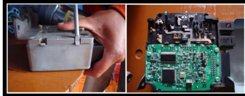
Figura 2.3. Desmontaje de la tapa metálica del módulo
