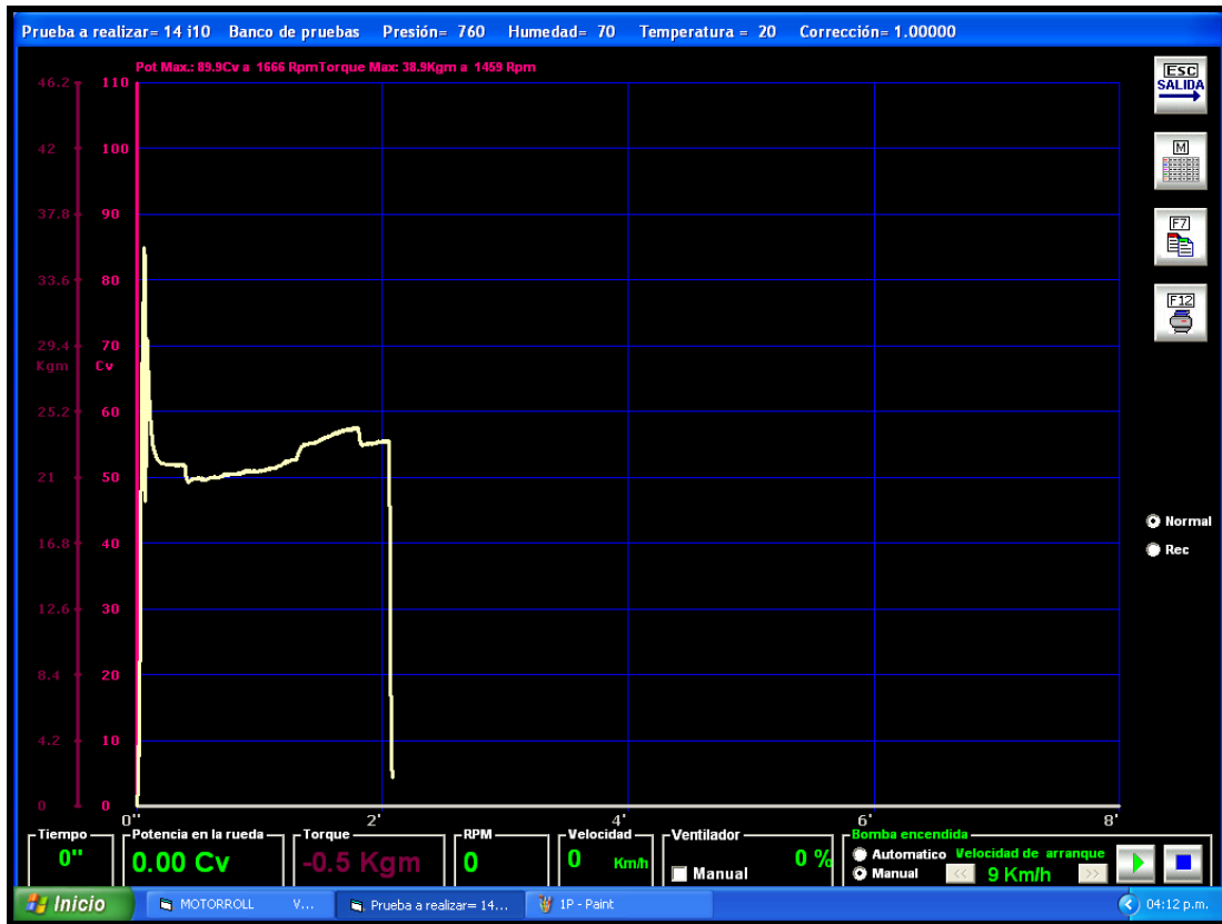
Figura 4.3. Primera prueba de potencia y torque del vehículo Hyundai i10 55 CV
