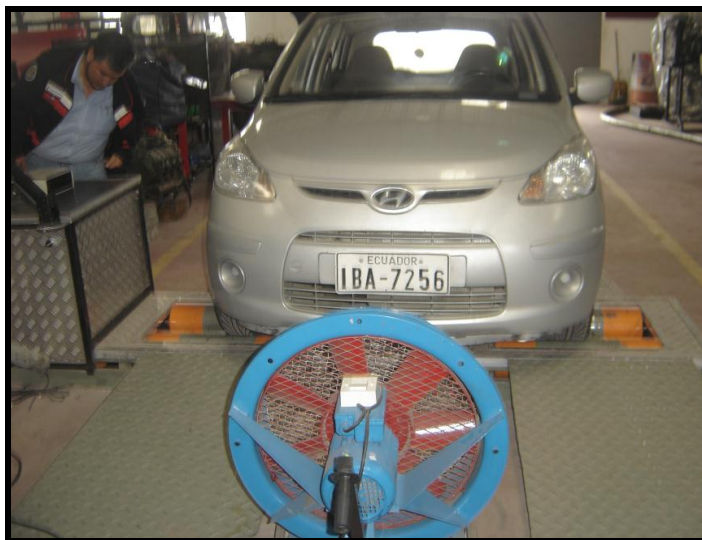
Figura 5.15. Vehículo Hyundai i10 en el dinamómetro
