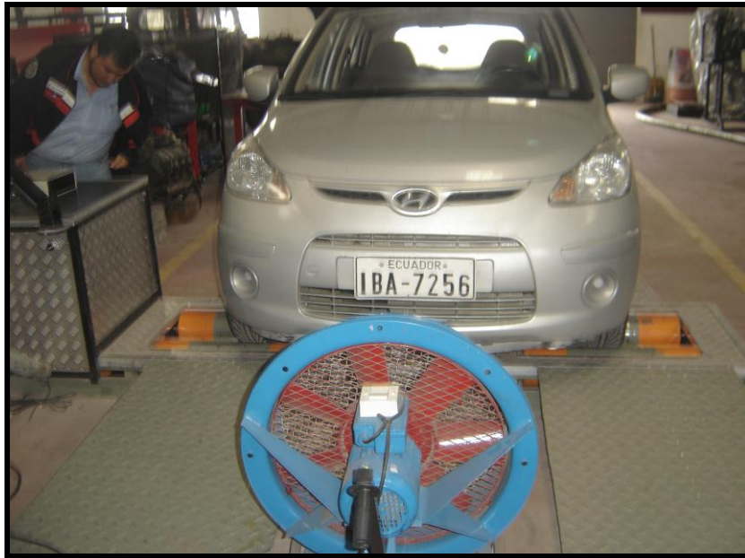
Figura 4.1. Montaje del vehículo Hyundai i10 sobre los rodillos del dinamómetro Desarrollar la calibración de las rpm de los rodillos que deberá ser a 2000 rpm.
