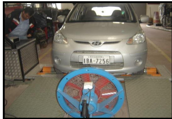
Figura 10. Vehículo Hyundai i10 en el dinamómetro
