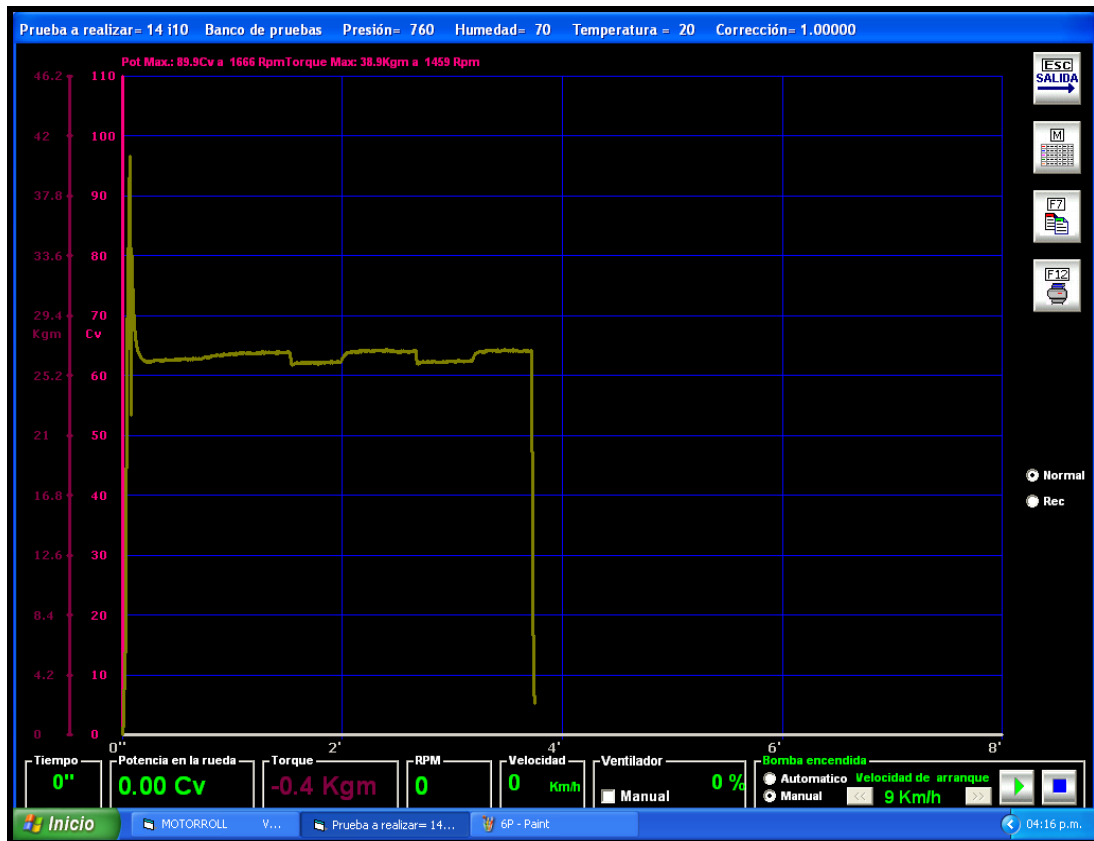
Figura 4.5. Medición de potencia y torque correcta 65 CV
