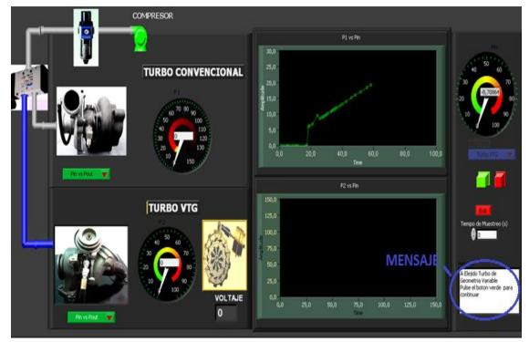
• Cuando se activa el motor, éste hará trabajar la bomba de vacío, necesaria para que funcione la geometría variable correctamente, luego debemos manipular el filtro regulador del flujo como con el turbo convencional, y tomaremos los
