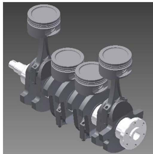
Figura 1a. Tren alternativo en Inventor
