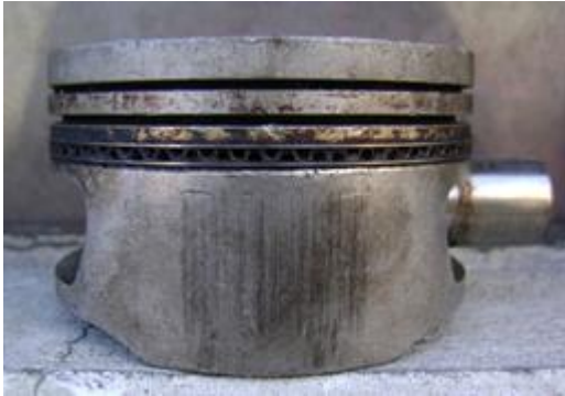
Figura 1j. Pistón visualización de la falla en condiciones de trabajo reales.
