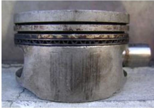
Figura No. 82: a) Falla Simulada en Ansys b) Falla Producida en la Vida Real
