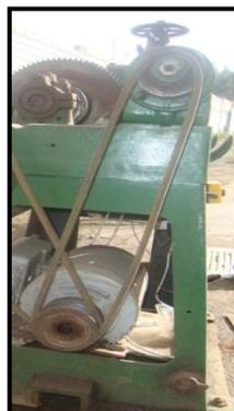
**Figura 1.1 Proceso de movimiento por polea para enderezar varilla**
