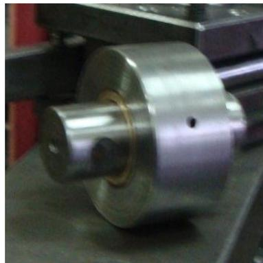
**Figura 4.4 Seguidor de leva**
