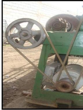
**Figura 1.2 Proceso de movimiento por polea para el trefilado de varilla**
