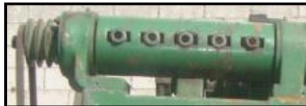
**Figura 1.3 Mecanismo de enderezado de varilla**
