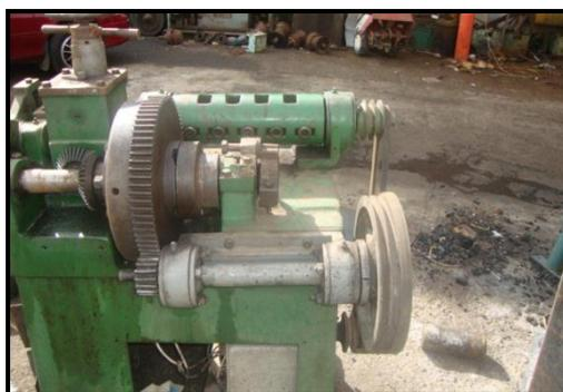
**Figura 1.4 Mecanismo de movimiento de rodillos de trefilación**
