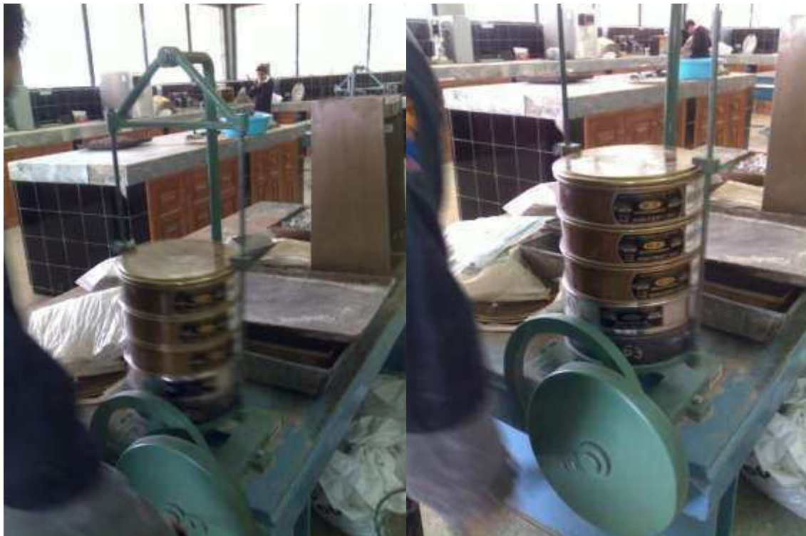
Figura 4.6. Ensayo de tamizado utilizando la maquina de separación por vibración
