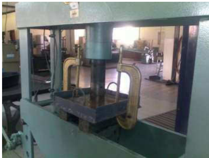
Figura 5.8. Mezcla sometida a 1,5 ton, de presión para su compactación.
