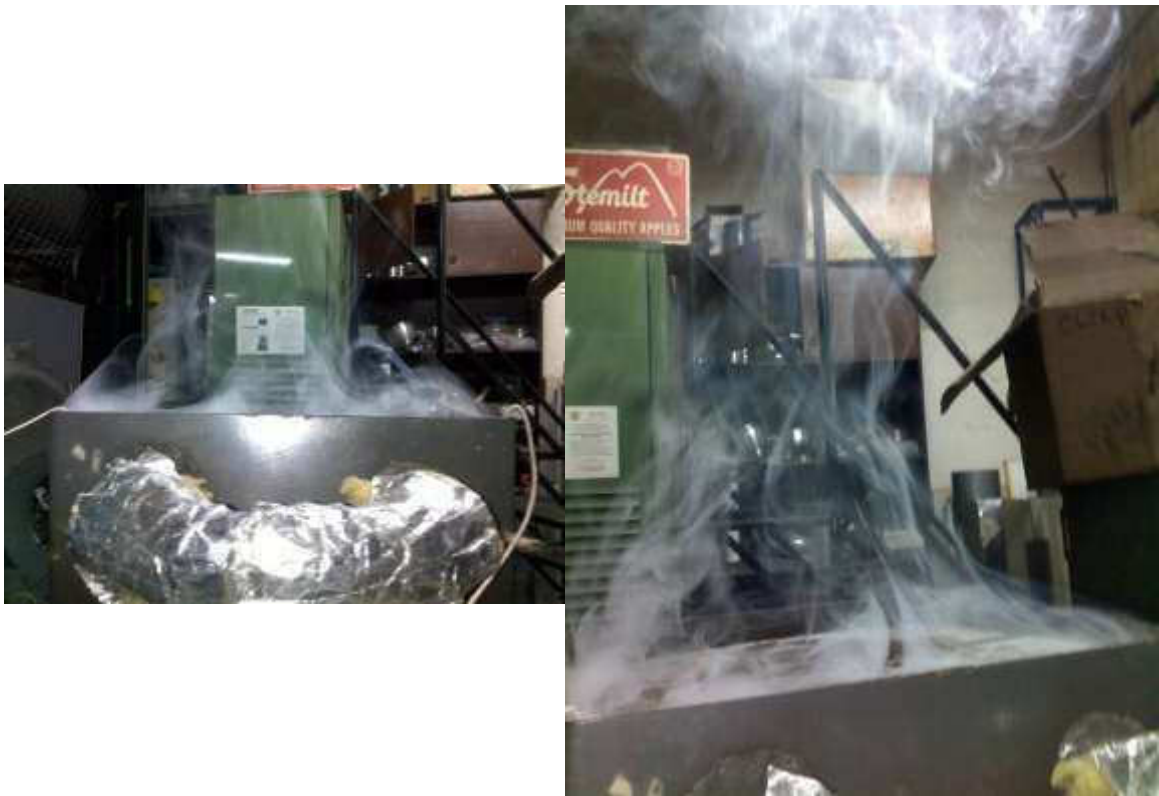
Figura 4.18. Prueba de conductividad térmica del nuevo aislante de cascarilla de arroz molida.
