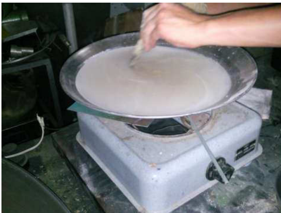
Figura 5.4. Mezcla del aglutinante diluido en agua caliente a 75°C, por cada mg de aglutinante se colocó 5ml de agua.
