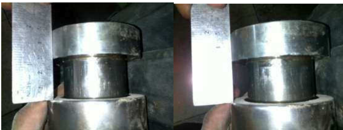
Figura 4.10. Tomada de la distancia recorrida por el punzón dentro de la matriz durante el ensayo de compactación
