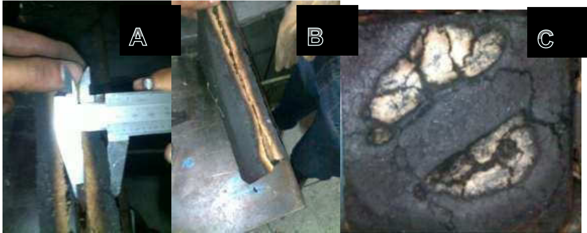
Figura 4.19. Prueba de conductividad térmica del nuevo aislante de cascarilla de arroz molida.
