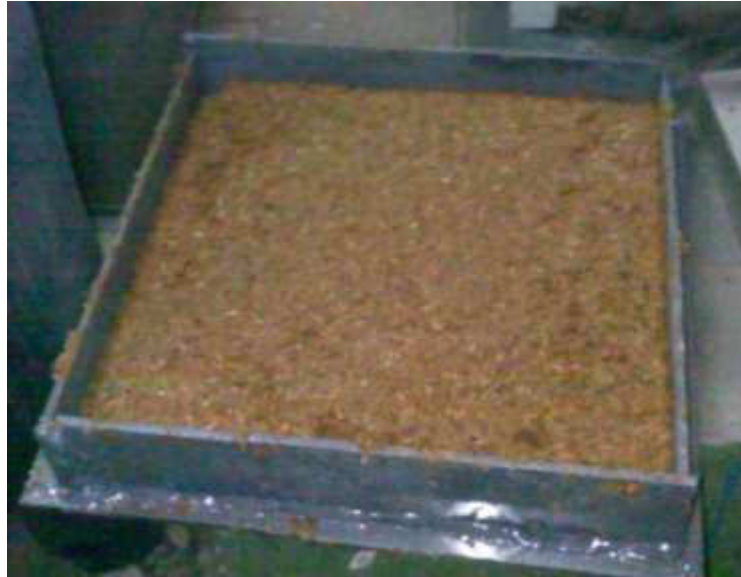
Figura 5. 7. b. Mezcla vertida en el molde previo a su compactación.
