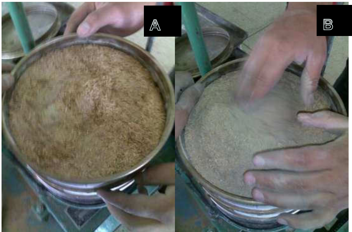
Figura 4.7. Muestra de como se va acomodando la cascarilla molida durante el procedo de tamizado
