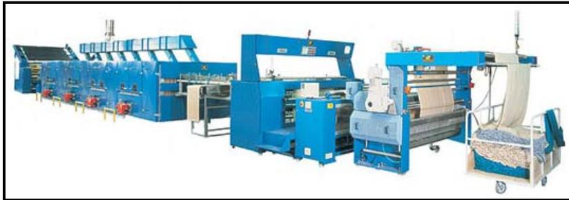
**Figura 3.3.17. Proceso de Secado (Rama)**
