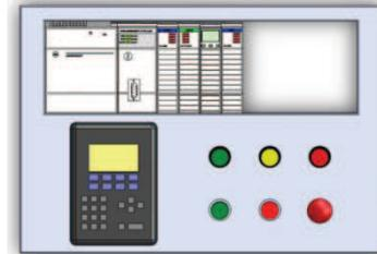
Figura. 7 Distribución de elementos del panel del operador
