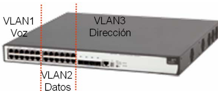
Figura 1.35. Muestra la creación de VLANS en un switch.
