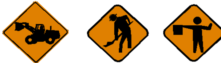
Figura 7.4 Señalización preventiva durante la etapa de construcción – Hombres y maquinaria trabajando
