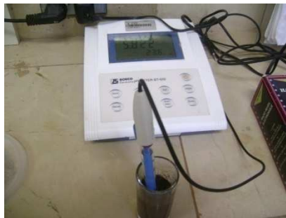
Figura 10. Determinación de pH de biopreparados
