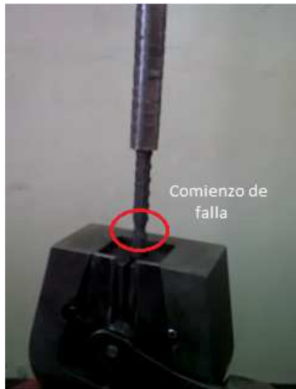
Figura 5. 8: Fallo del empalme.
