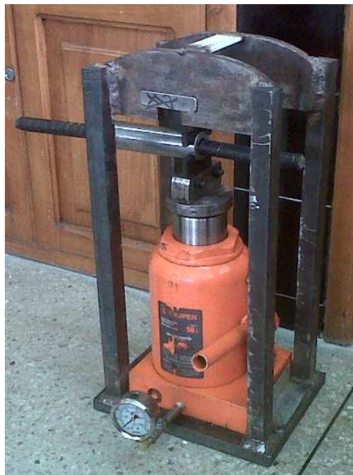
Figura 5. 3: Posicionamiento de conector con varillas en la prensa.
