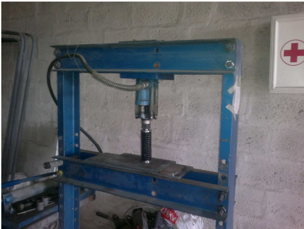
Foto 10: Pruebas de presión en resorte de válvula 2"
