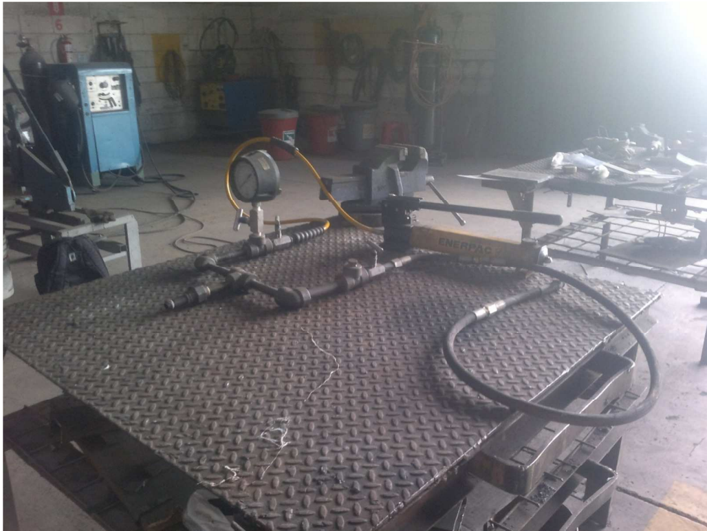
Foto 21: Equipo de presión para pruebas en válvulas de 2" y 4"
