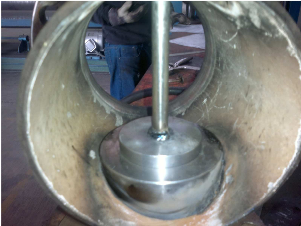
Foto 17: Soldadura de eje al disco de asiento en posición de operación
