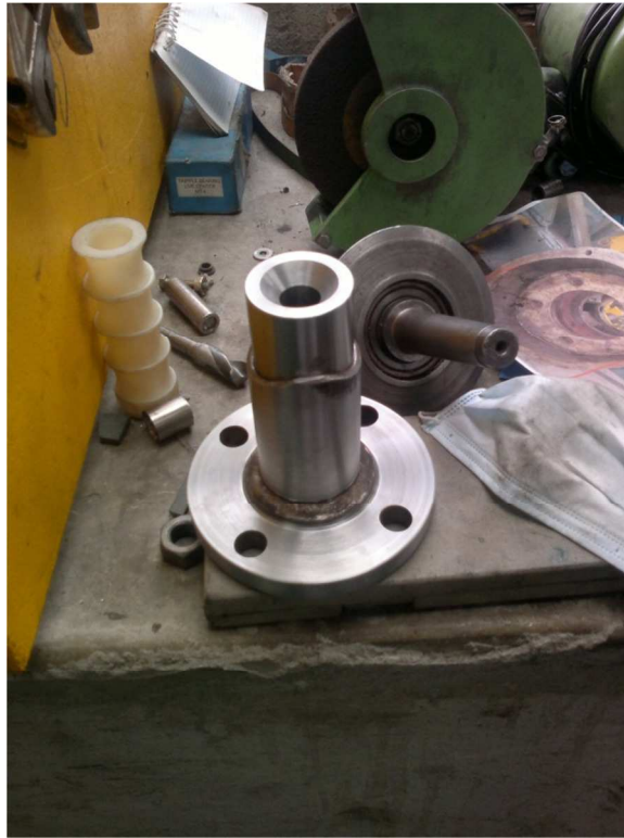
Foto 5: Conjunto: boquilla – entrada de 2”
