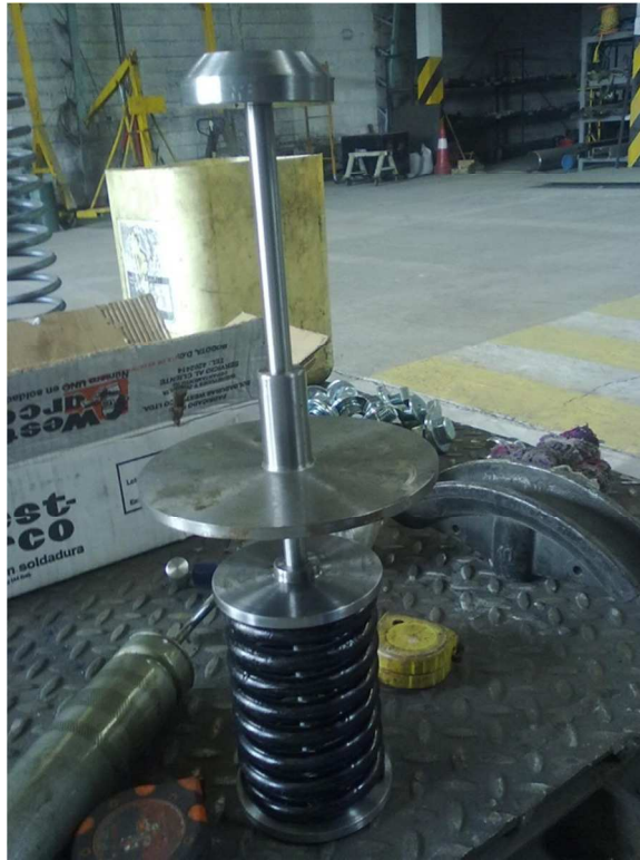
Foto 15: Mecanismo de alivio de válvula de 4"
