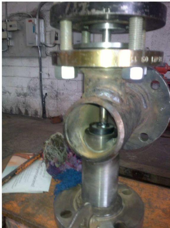
Foto 18: Montaje de bonete al cuerpo de válvula
