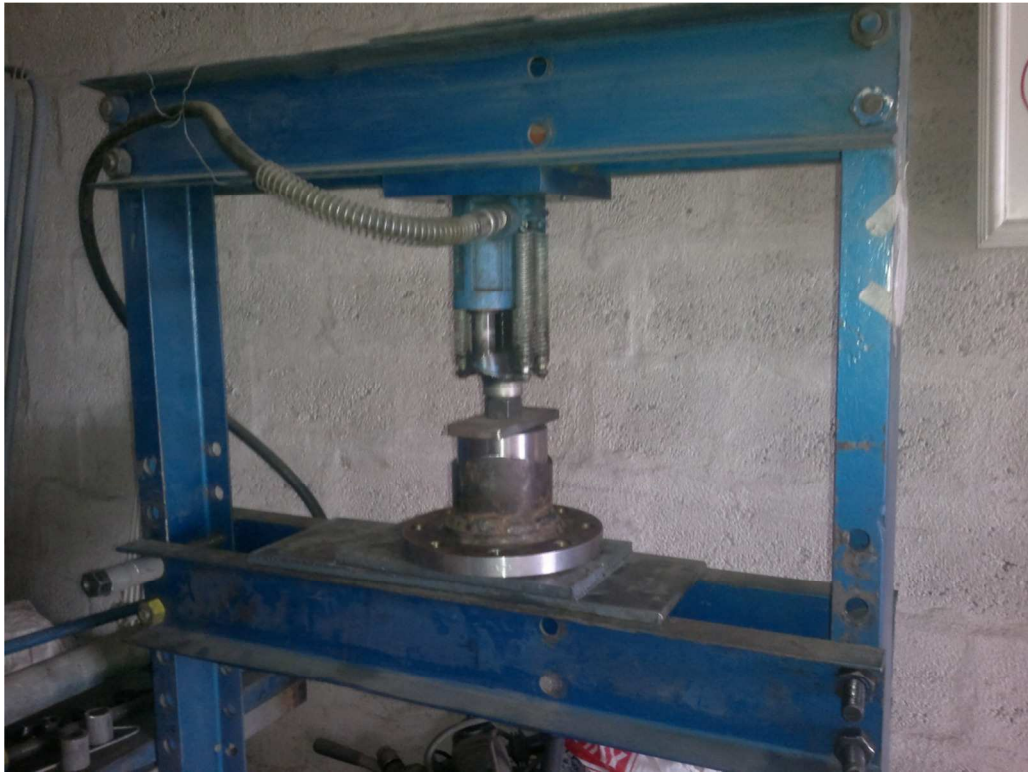
Foto 9: Montaje de boquilla en entrada de 4"
