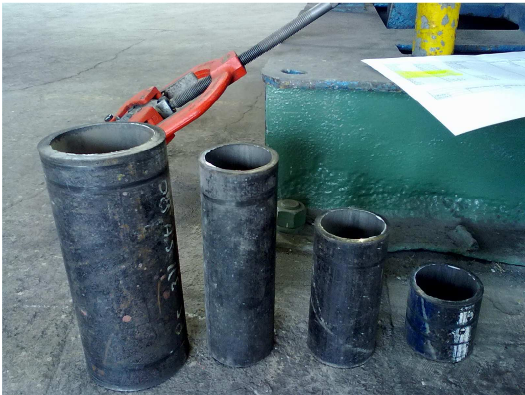
Foto 12: Tubería en diferentes medidas para válvula de 2"
