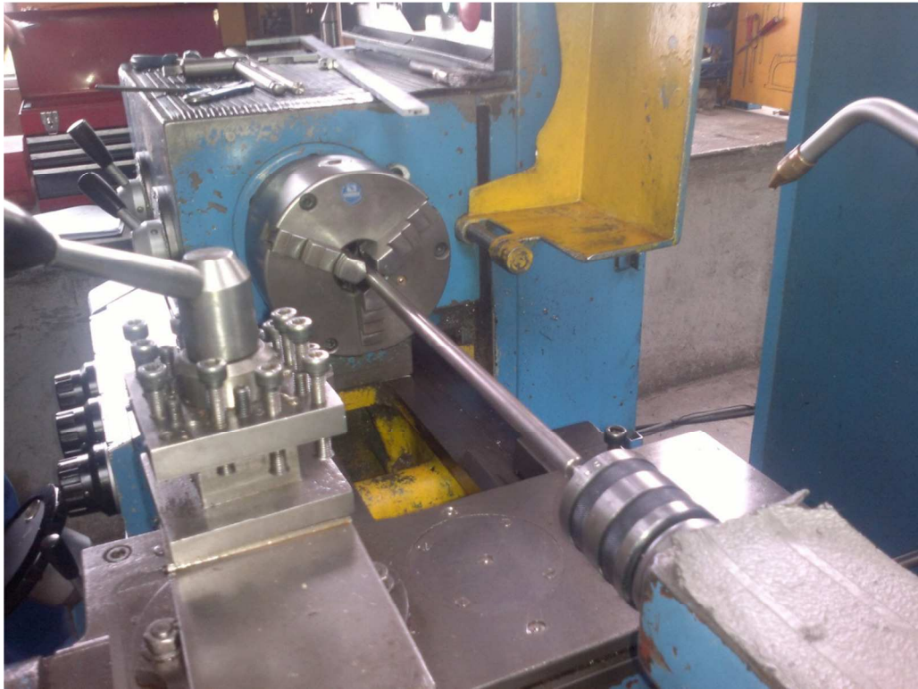
Foto 7: Maquinado de eje guía
