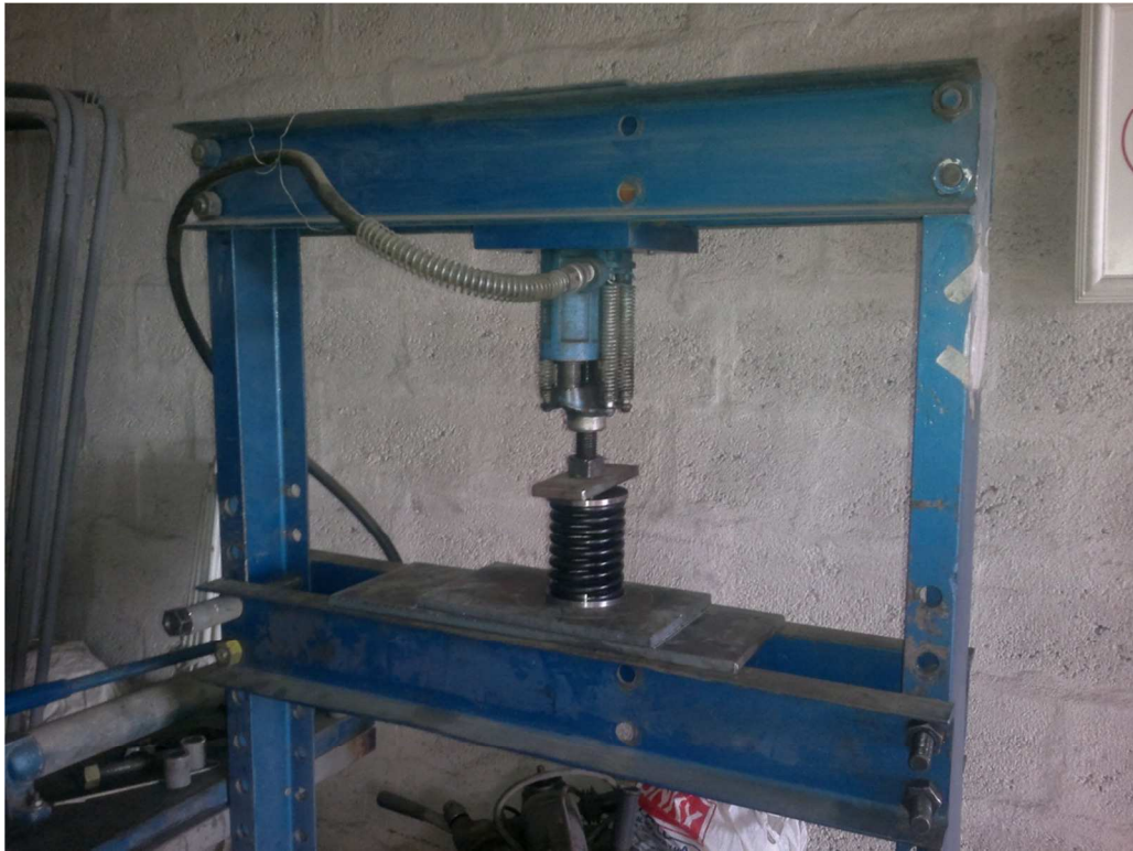
Foto 11: Pruebas de presión en resorte de válvula de 4"
