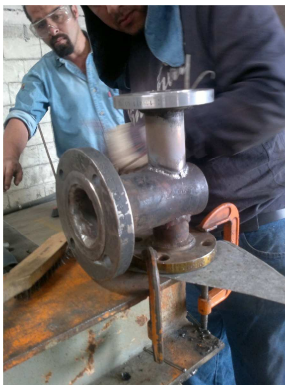
Foto 14: Soldadura de Tubería de 2" a cuerpo de válvula
