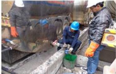
Muestreo de cemento asfáltico.
