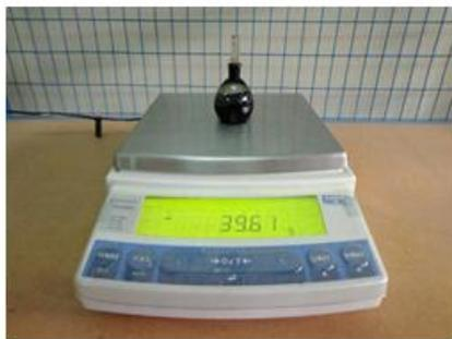
Equipo para prueba de Peso específico al asfalto.
