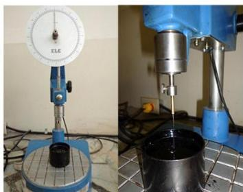
Equipo para prueba de Penetración al asfalto.
