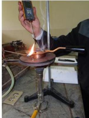
Equipo para prueba de Inflamación al asfalto.
