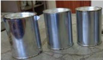
Recipientes metálicos para Muestreo de cemento asfáltico.
