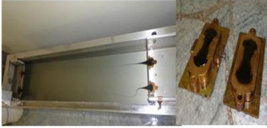
Equipo para prueba de Ductilidad al asfalto.
