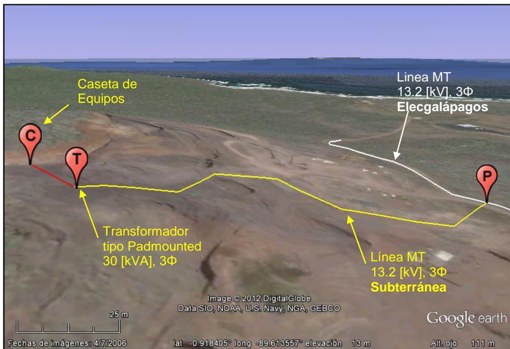
Figura 3. 2. Tendido de línea trifásica de media tensión, Cantera de piedra, San Cristóbal.<sup>190</sup>
