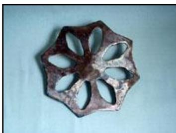
Figura 1. 38. Electrodo de puesta a tierra tipo placa-estrella<sup>100</sup>
