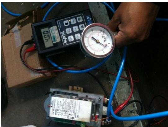
Fig. 16 Calibración del transductor de presión
