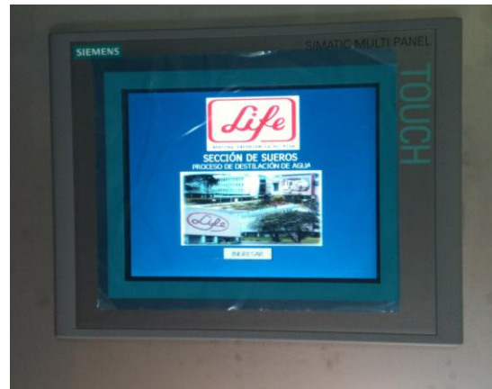
Fig. 18 Programa HMI cargado en la pantalla táctil
