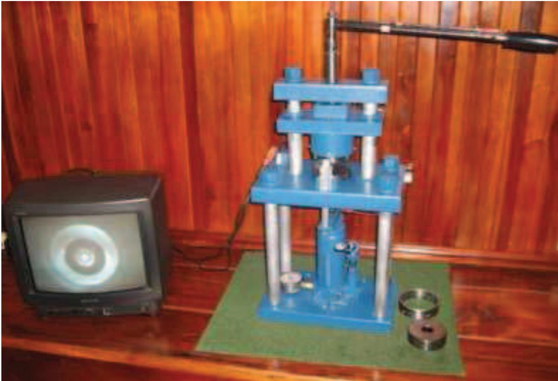
**Figura 4.8** Equipo para Pruebas de Embutición de Láminas Metálicas Tipo Erichsen.
