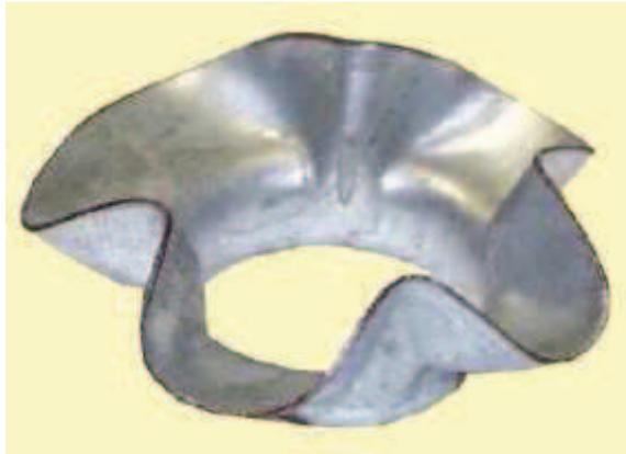
**Figura 2.10** Pieza Embutida Rota como Consecuencia de un Juego de Embutición Demasiado Pequeño <sup>16</sup>
