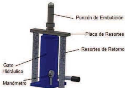
**Figura 2** Sistema Hidráulico de Embutición.
