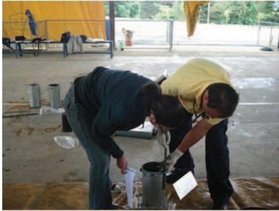
Fig.2.4 Ensayos de muestra de cilindros de hormigón
