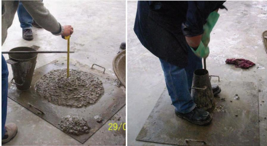
Fig. 2.6. Toma de muestra para asentamiento de hormigón
