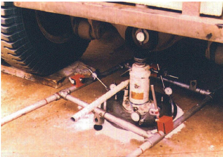
Fig. 3.3 ensayo de reacción con camión
