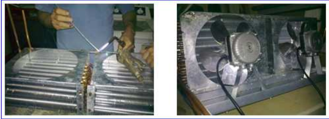
Figura 4.14. Evaporadores y ventiladores del sistema
