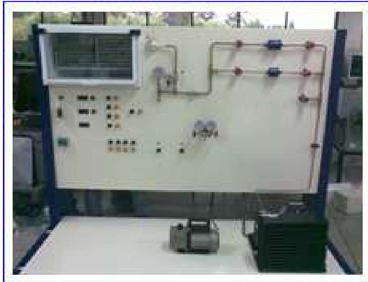
Figura 4.11. Ubicación de la bomba de vacío en la mesa de apoyo
