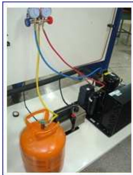
Figura 4.33 Conexiones para realizar vacío al sistema
