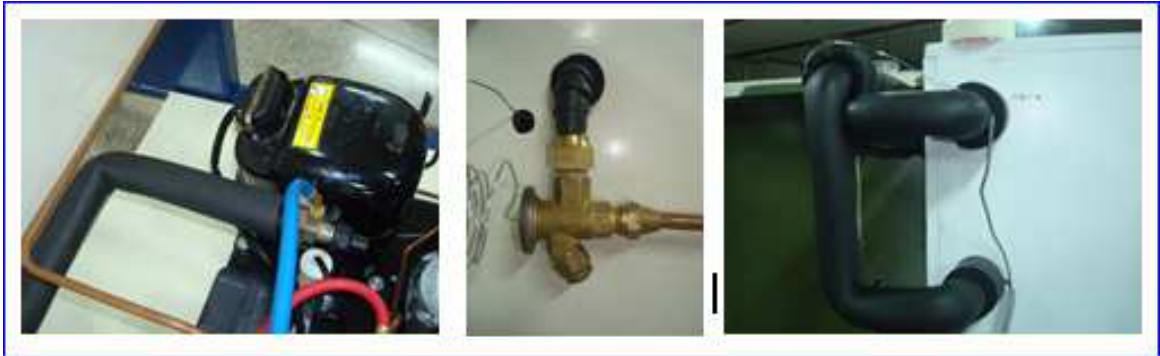
Figura 4.22. Ubicación del aislamiento térmico
