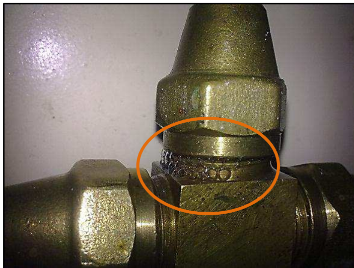
Figura 2.10 Fuga en una unión roscada detectada por la formación de burbujas.
