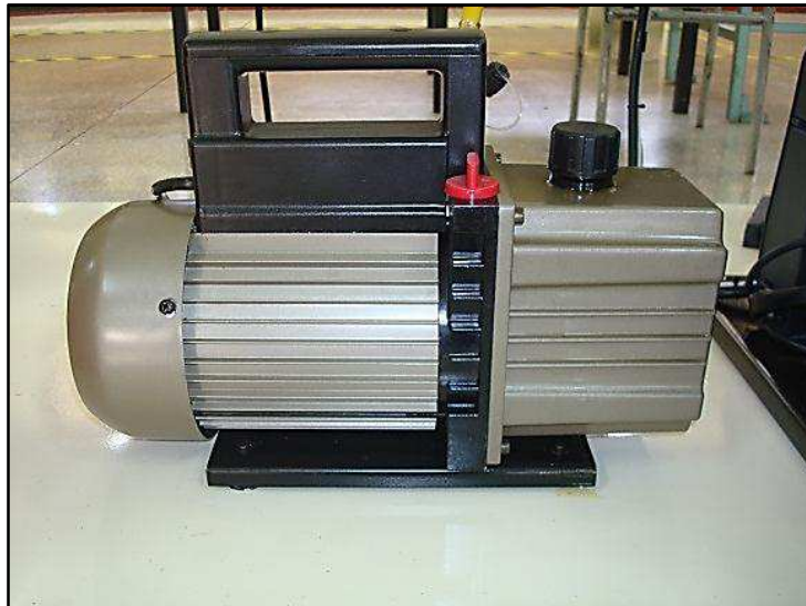
Figura 2.9 Bomba de vacío
