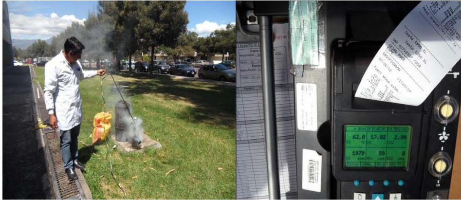
Figura 4.4 Prueba de gases contaminantes
