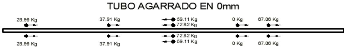
**Figura 4. 34 Reacciones horizontales al insertar el tubo de 4.5''**
