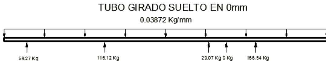
Figura 4. 48 Reacciones verticales en el tubo de 4.5" en su posición inicial después del giro
