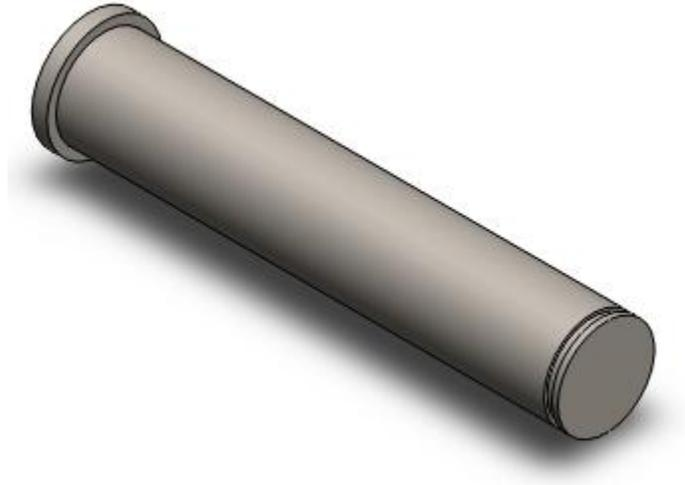
**Figura 4. 93 Pasador: placa base - palanca**
