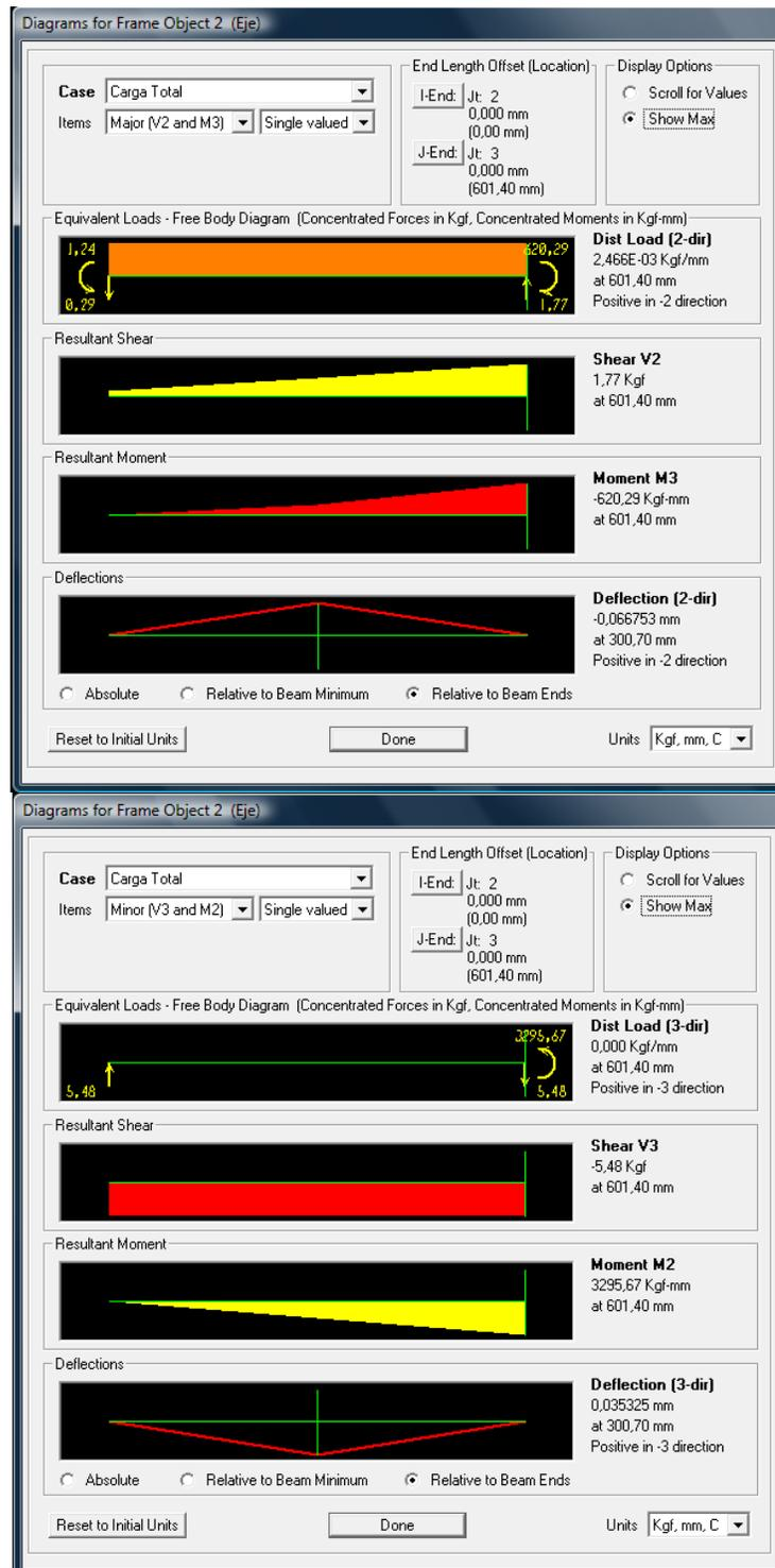
Figura 4. 421 Diagramas de fuerzas y momentos en la sección crítica del eje para soporte de catalinas
