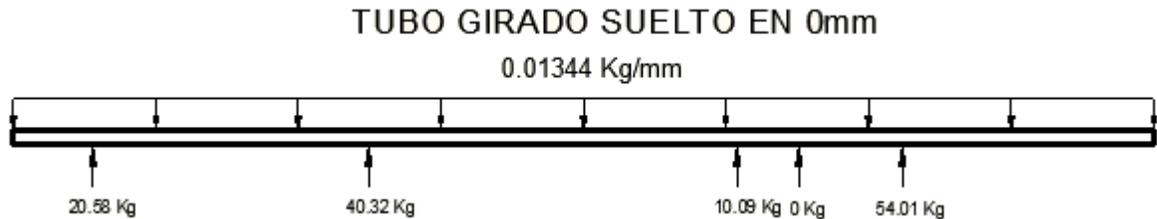
**Figura 4. 21 Reacciones verticales en el tubo de 2 3/8" en su posición inicial después del giro**
