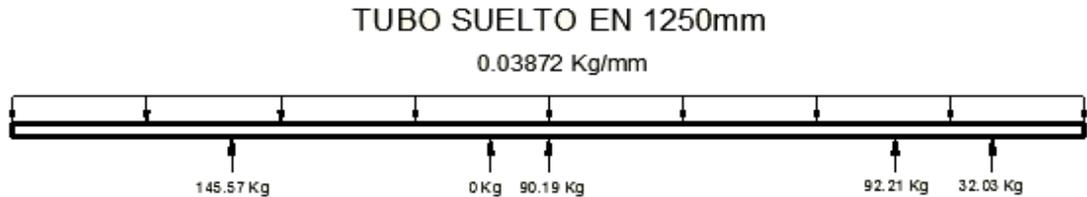
**Figura 4. 35 Reacciones verticales en el tubo de 4.5'' en su posición final**
