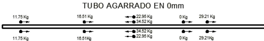
**Figura 4. 42 Reacciones horizontales al insertar el tubo de 2 3/8"**
