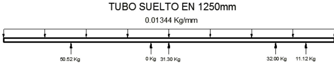
**Figura 4. 15 Reacciones verticales en el tubo de 2 3/8" en su posición final**
