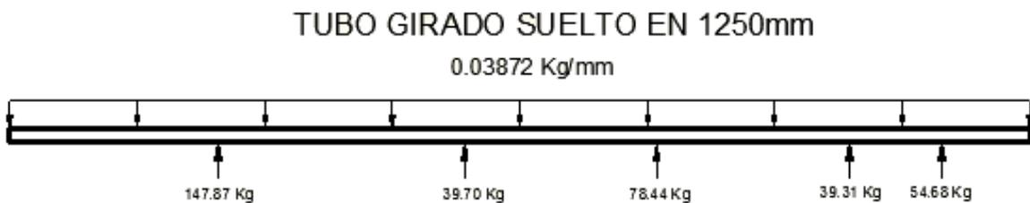
**Figura 4. 52 Reacciones verticales en el tubo de 4.5” en su posición final después del giro**
