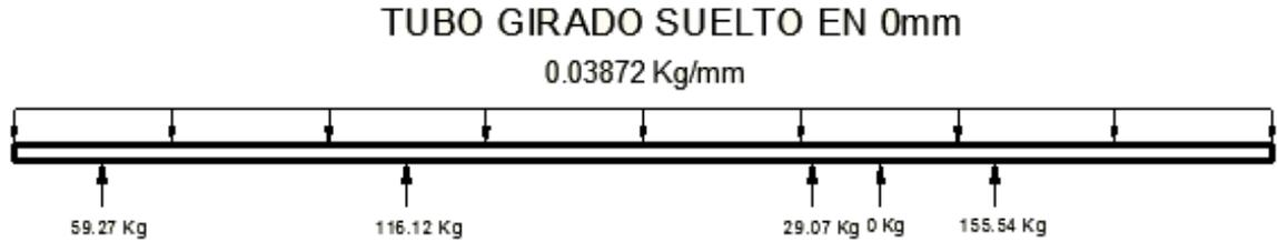
**Figura 4. 18 Reacciones verticales en el tubo de 4.5” en su posición inicial después del giro**
