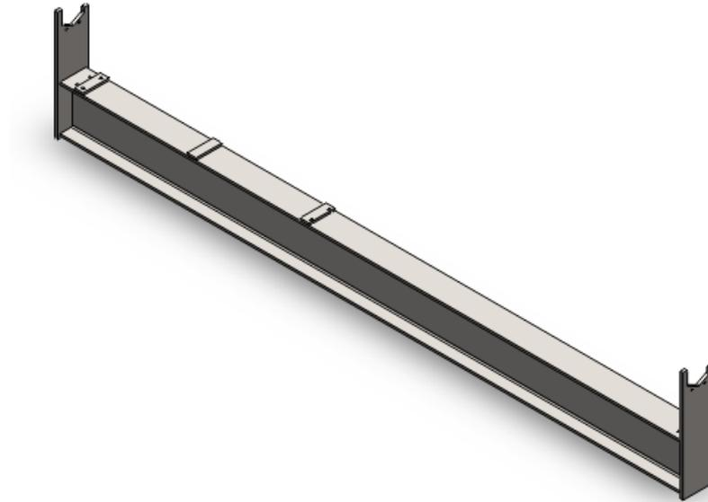
**Figura 4. 186 Viga de levantamiento**
