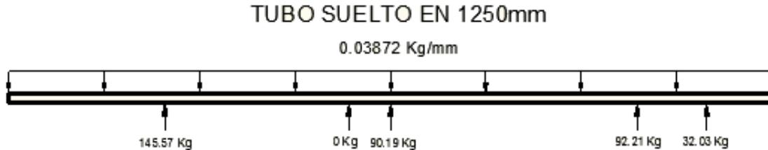
**Figura 4. 12 Reacciones verticales en el tubo de 4.5” en su posición final**
