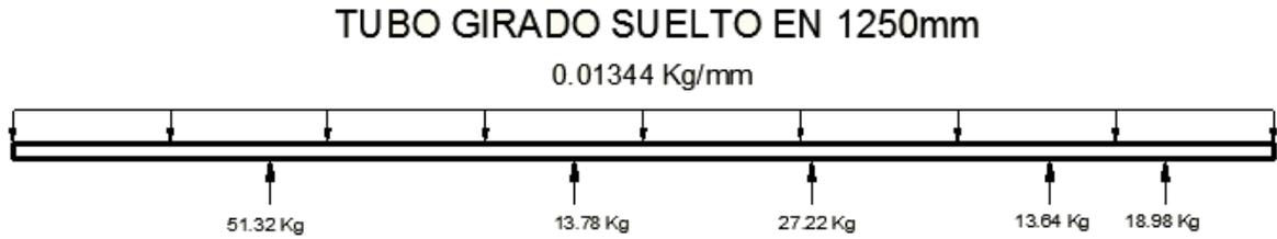
**Figura 4. 27 Reacciones verticales en el tubo de 2 3/8" en su posición final después del giro**
