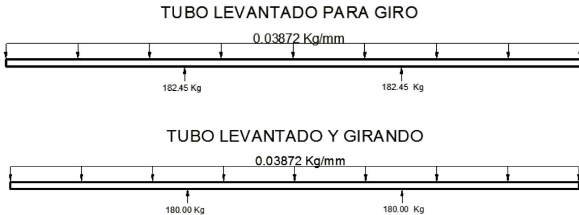
**Figura 4. 4 Reacciones verticales durante el levantamiento**
