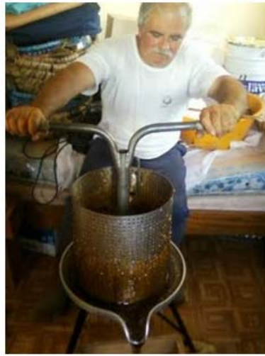
Prensado de los panales de miel, en una prensa de aluminio, realizado manualmente.
