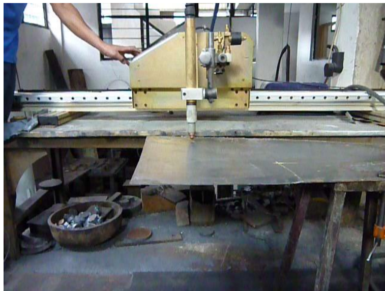
Figura 3.6 Colocación y Fijación de Elemento de Trabajo.
