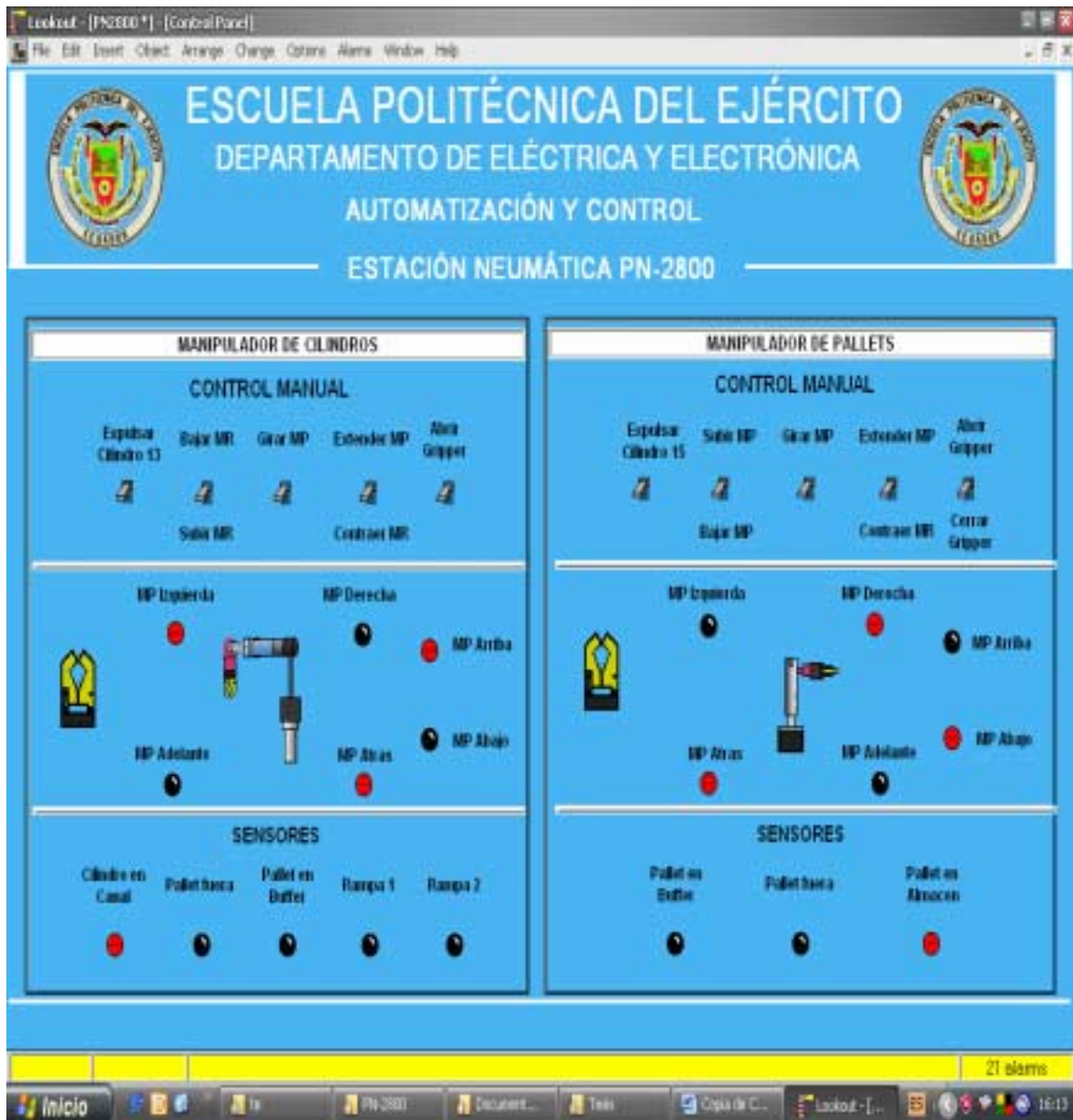
Figura. 6.14. Panel de control del HMI.
