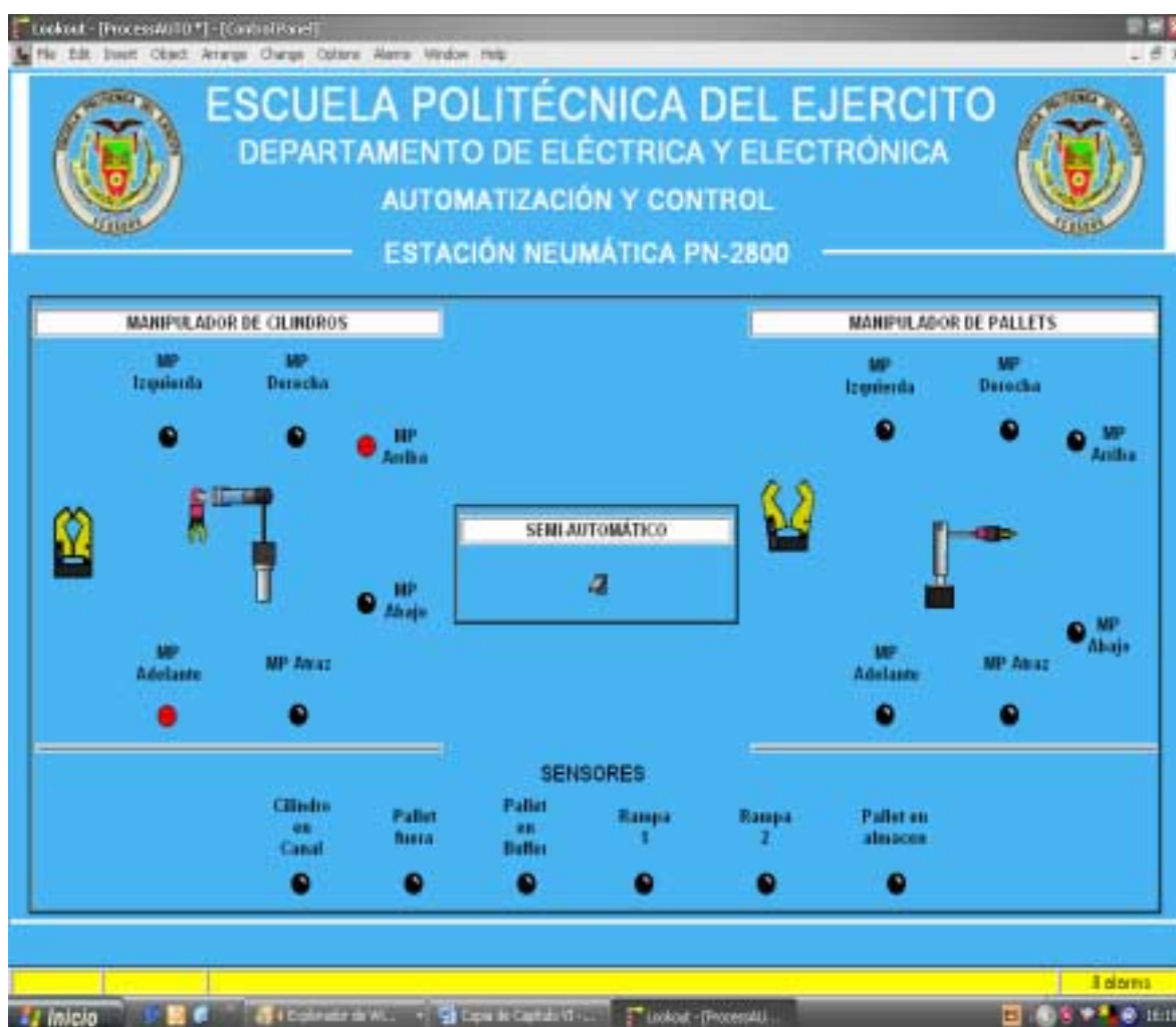
Figura. 6.17. Control y monitoreo Semi-automático para el Manipulador de Cilindros y Pallets.
