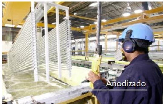
FIGURA N° 5: PROCESO DE ANODIZADO
