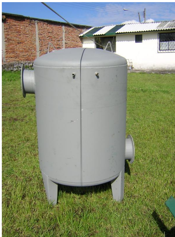
Figura 5.1 Tanque Biodigestor (cap. 800 L)
