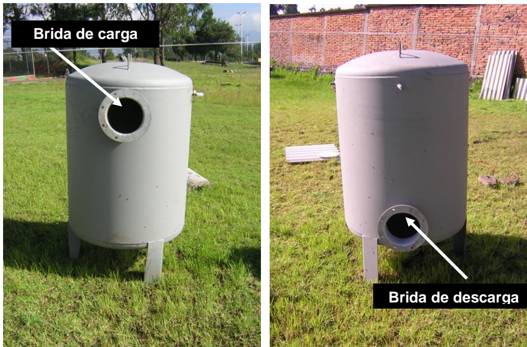
Figura 5.2 Bridas de carga y descarga.
