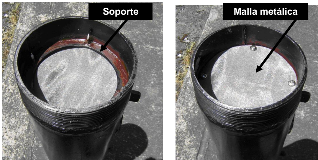
Figura 4.5 Soporte y malla metálica
