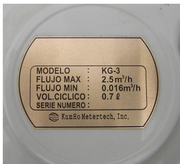
Figura 5.14 Características del caudalímetro
