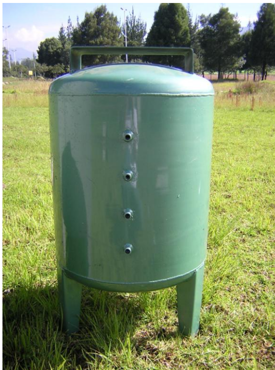
Figura 5.7 Tanque para acumulación de biogás (cap. 200 L)
