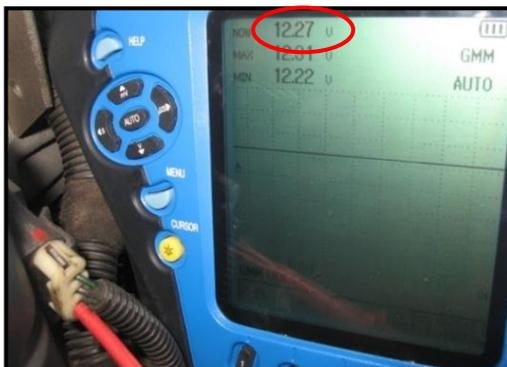
Figura 11. Verificación de terminales de la bobina.
