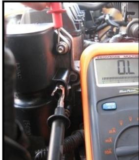
Figura 14. Diagnóstico con multímetro y osciloscopio.
