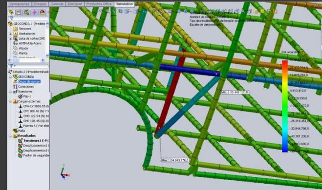
En la figura se muestra el valor mínimo del esfuerzo normal de -55 MPa afectado al larguero izquierdo del piso de la estructura nos indica que el elemento está sometido a compresión.
