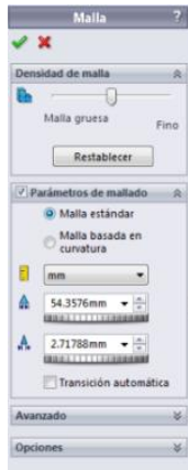
Fig. 3.24.- Selección de la densidad de malla, parámetros de mallado.
