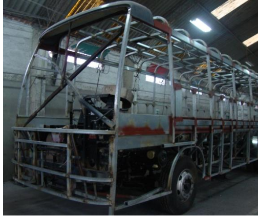
Fig. 1.16.- Estructura metálica empleando Acero ASTM-A36, A500.
